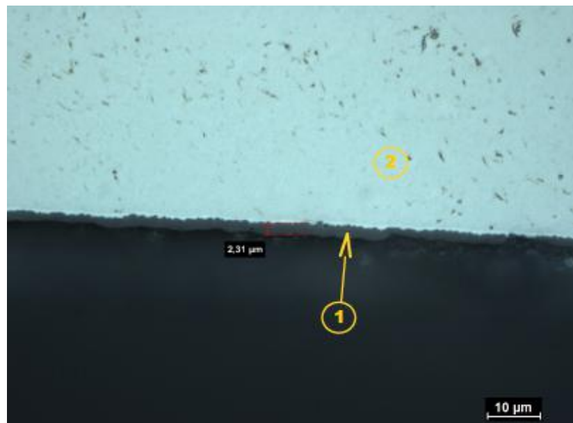
Obrázok 13 – Priečny prierez trubky ZIRLO s polykrýštalickou diamantovou vrstvou po procese oxidácie počas 3 dní pri 400 °C s detailom na vnútorné rozhranie získaný optickým mikroskopom. (1) oxidová vrstva ZrO_2 s hrúbkou 2,31 \mu m (2) Zr substrát bez prítomnosti \beta -fáze. [15]
