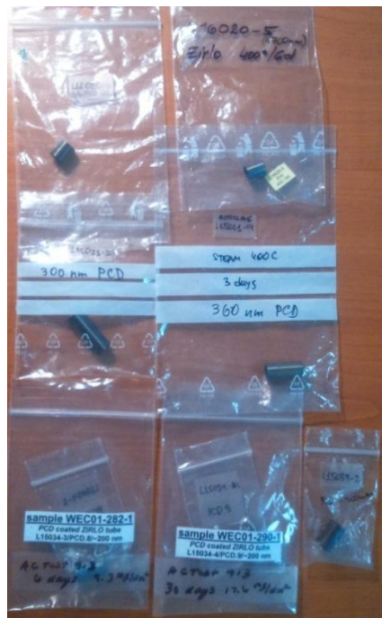
Obrázok 21 – Fotografie vzoriek ZIRLO s 200 nm, 300 nm a 700 nm polykryštalicou diamantovou vrstvou pred i po procese autoklávovania alebo oxidácie horúcou parou. [16]
