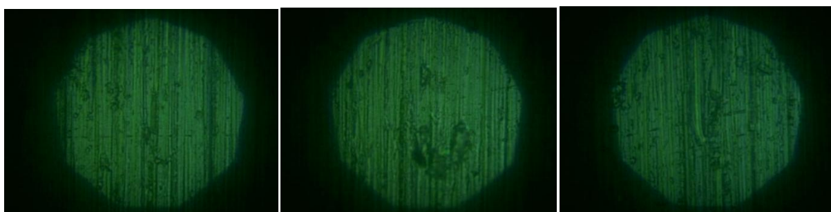
Obrázok 22 – Mikroskopické pohľady na vzorku ZIRLO s 200 nm polykryštalicovou diamantovou vrstvou, konkrétne sa jedná o okolia bodu 1,2 a 3, z ktorých sa získali príslušné Ramanove spektrá.
