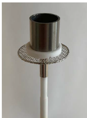
Obr. 6.1: Držiak na vzorku s platínovou sieťkou a hliníkovým prstencom.
