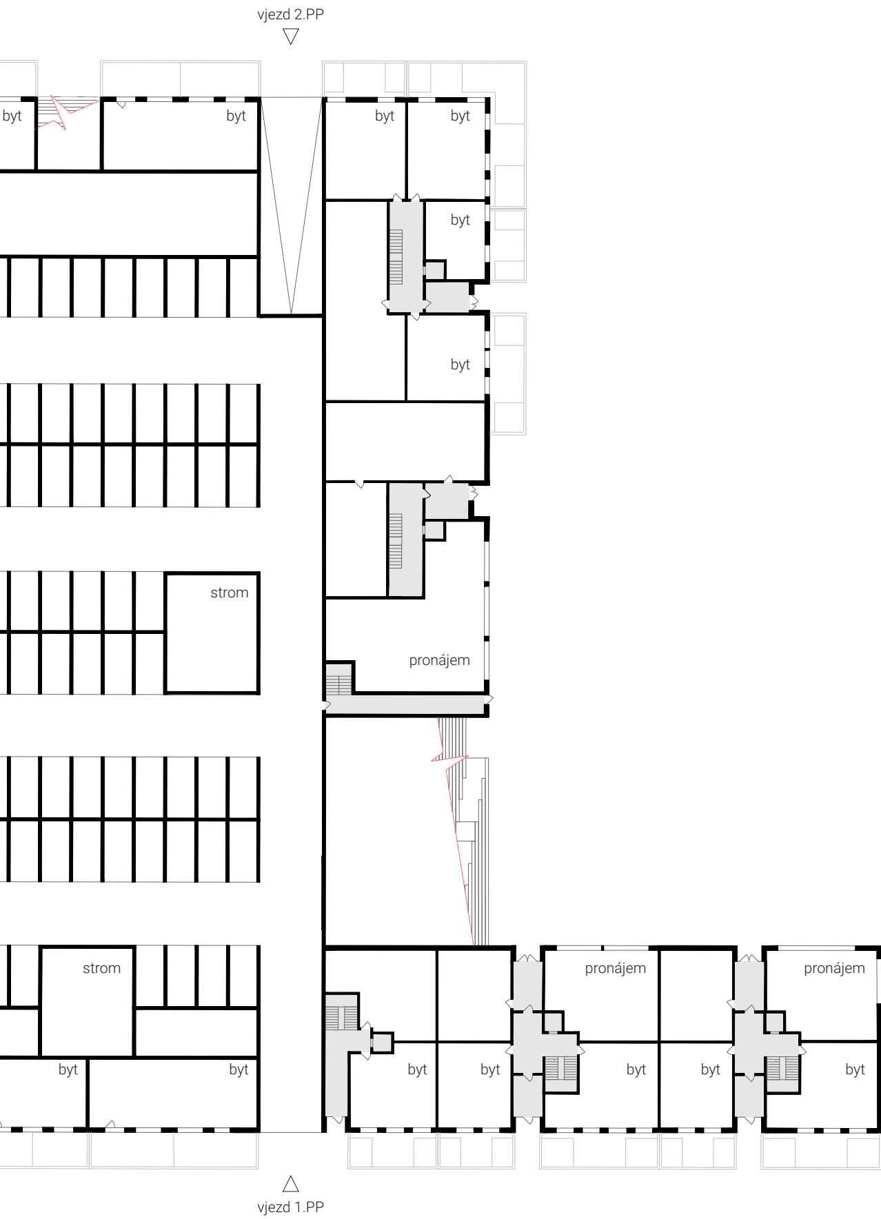
nové řešení stávajících garáží 1.PP 1:500
