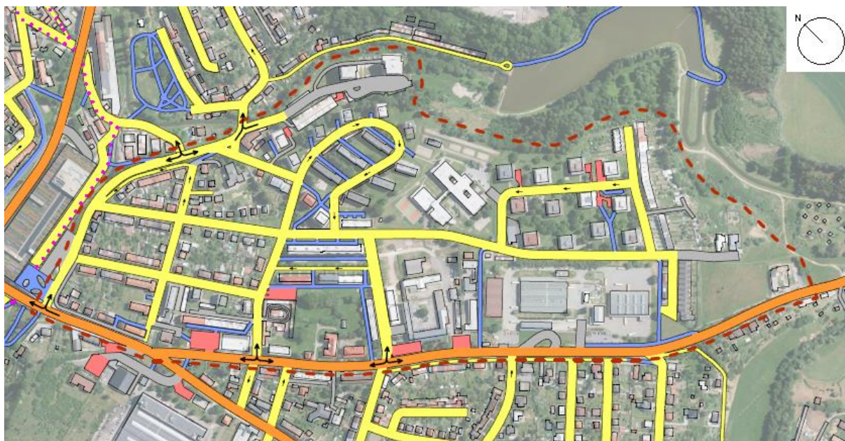
Obrázek 8: Stávající organizace dopravy v oblasti, podklad z [2] oranžová: sběrná komunikace, žlutá: obslužná komunikace, modrá: komunikace s vyloučením motorového provozu, šedá: účelová komunikace, červená: plocha parkování, růžová tečkovaná: cyklotrasa
