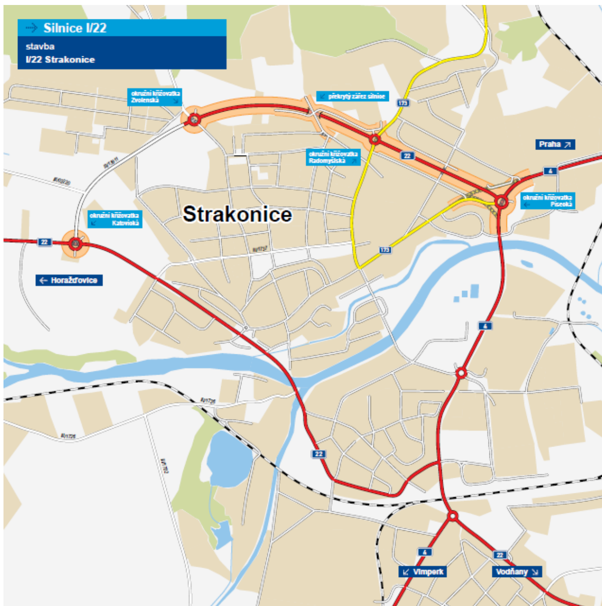
Obrázek 11 – Schéma silniční sítě ve Strakonících po zprovoznění obchvatu [8]
