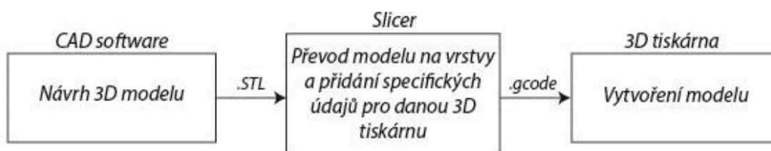
Obrázek 14 Pracovní postup při návrhu pro 3D tisk
