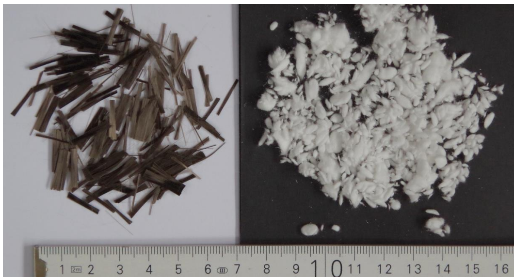
Obrázek 23 Čedičová vlákna 12,7 mm (vlevo) a keramická vlákna Izowat 12G (vpravo) použitá v experimentálním programu.
