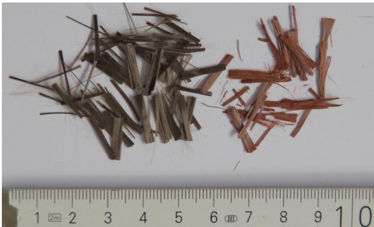
Obrázek 64 Barevné změny čedičových vláken – vlevo při laboratorních podmínkách a vpravo po výpalu při 1000 °C
