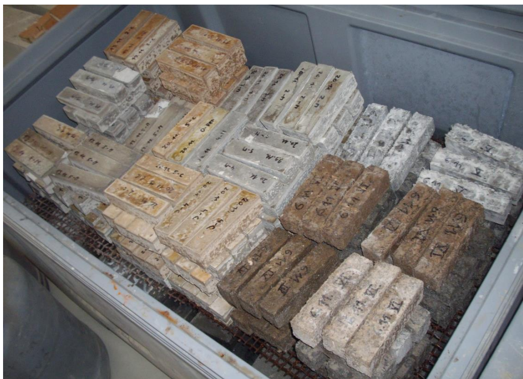
Obrázek 33 Uchování vzorků s různou příměsí metakaolinu a cihelného prachu v uzavřeném boxu s vysokou relativní vlhkostí.
