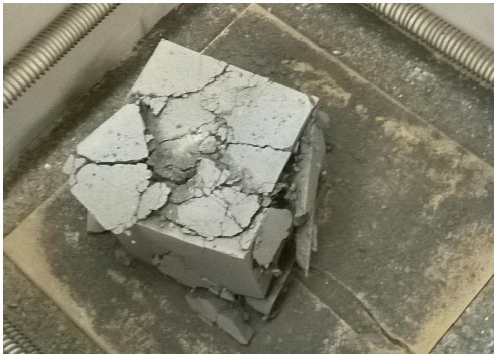
Obrázek 11 Krychle o hraně 150 mm zhotovená z UHPFRC po účinku teploty v úrovni 400 °C.
