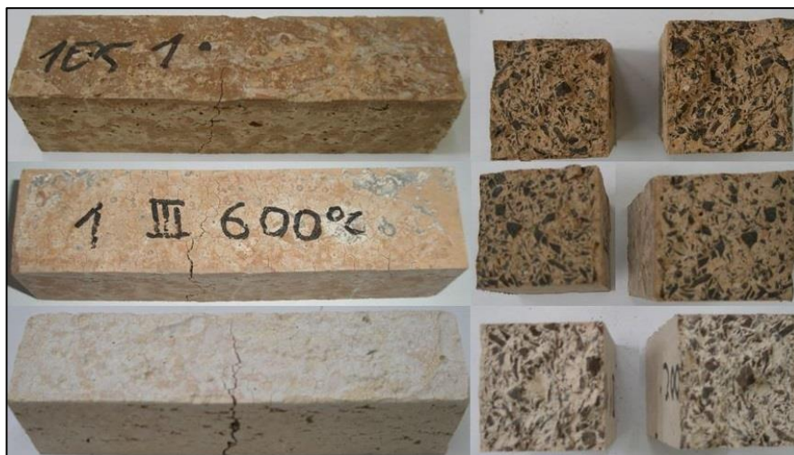
Obrázek 36 Ilustrace barevných změn vlivem výpalu na vzorcích se substitucí cihelným prachem (shora 105 °C, 600 °C a 1000 °C); jedná se o vzorky po provedené ohybové zkoušce, kdy vpravo je možné vidět vnitřní strukturu materiálu.
