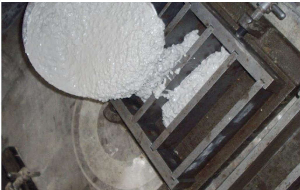
Obrázek 32 Ukládání čerstvé směsi obsahující keramická vlákna Izowat 12G a metakaolin.
