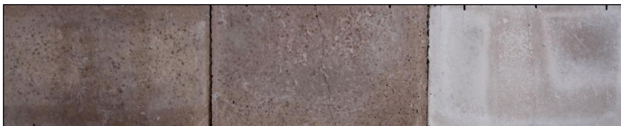
Obrázek 87 Barevné změny vlivem účinku vysokých teplot (105 °C, 600 °C a 1000 °C).
