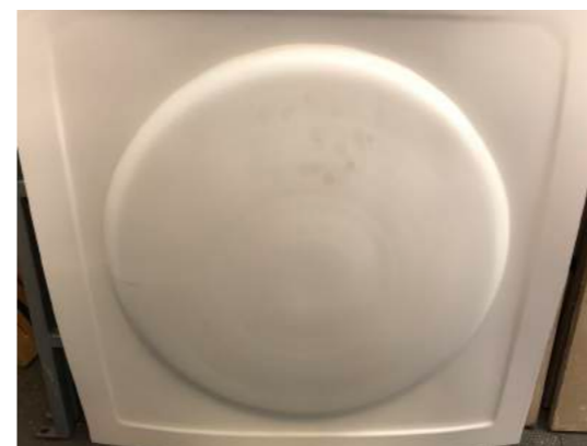
nanečisto vyvakuovaný tvar do HPS
