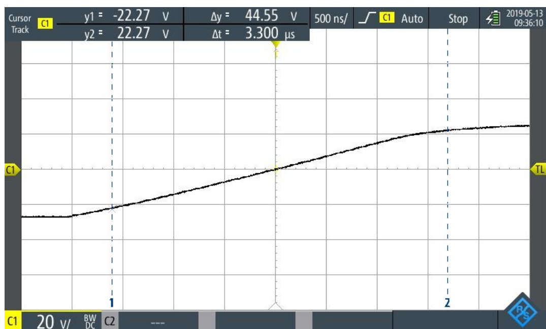
Obrázek 9.12: Měření náběžné hrany výstupního signálu
