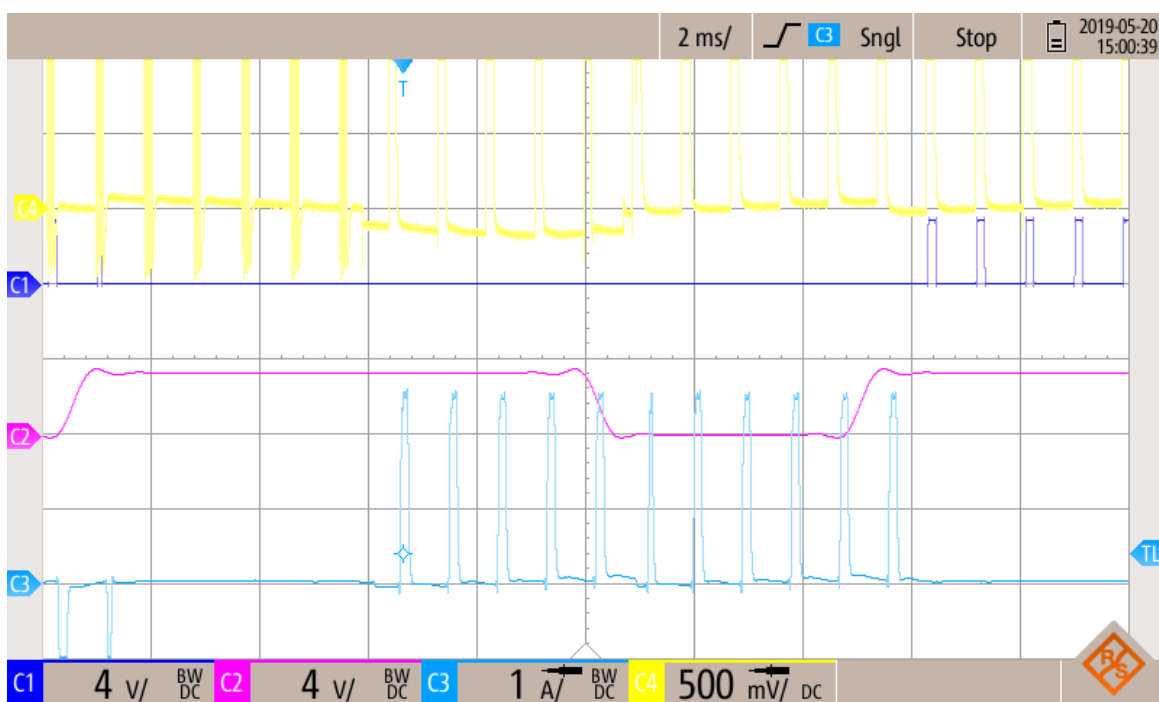
Obrázek 42 zobrazené průběhy PWM (C1), „Enable“ (C2), proudu (C3) a BEMF (C4)
