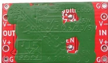
Obr.61 - DPS stabilizátoru s dodatečným zamaskováním
