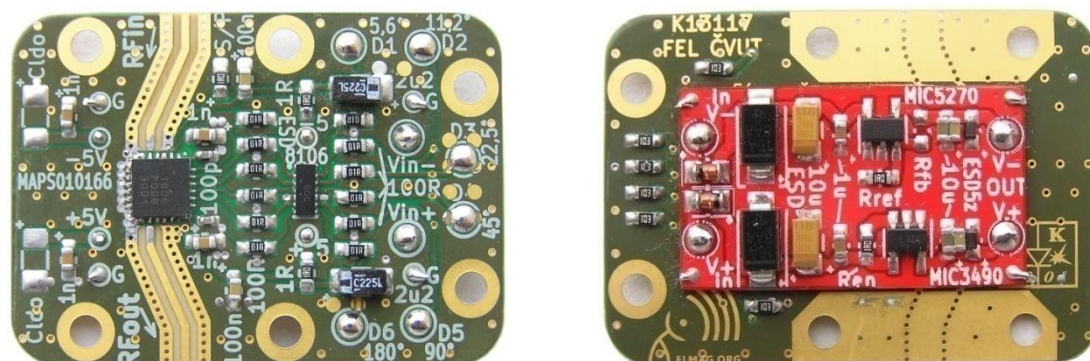
Obr.68 - Osazená DPS fázovače MAPS-010166 se stabilizátorem
