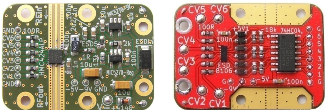
Obr.45 - Osazená DPS zeslabovače HMC424A s invertorem
