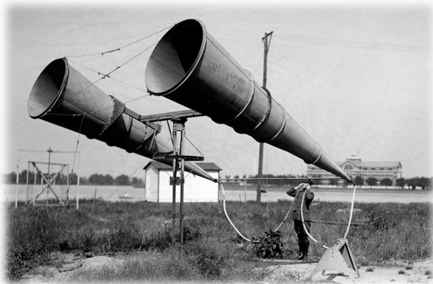
Obr.1 - Zařízení pro poslechovou detekci letadel, USA 1921
