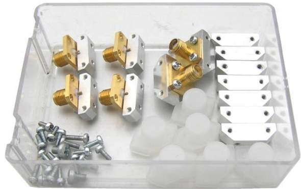
Obr.82 - Sada na testování se SMA konektory
