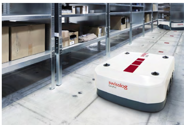
Obrázek 23 underdrive AGV (swisslog, 2019)
