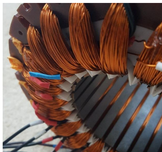
Obr. 6.2 Provedení toroidního vinutí pro motor T22V525
