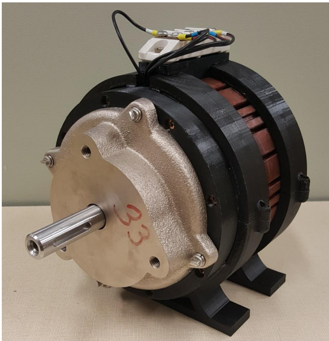
Obr. 6.5 Sestava toroidně vinutého stroje
