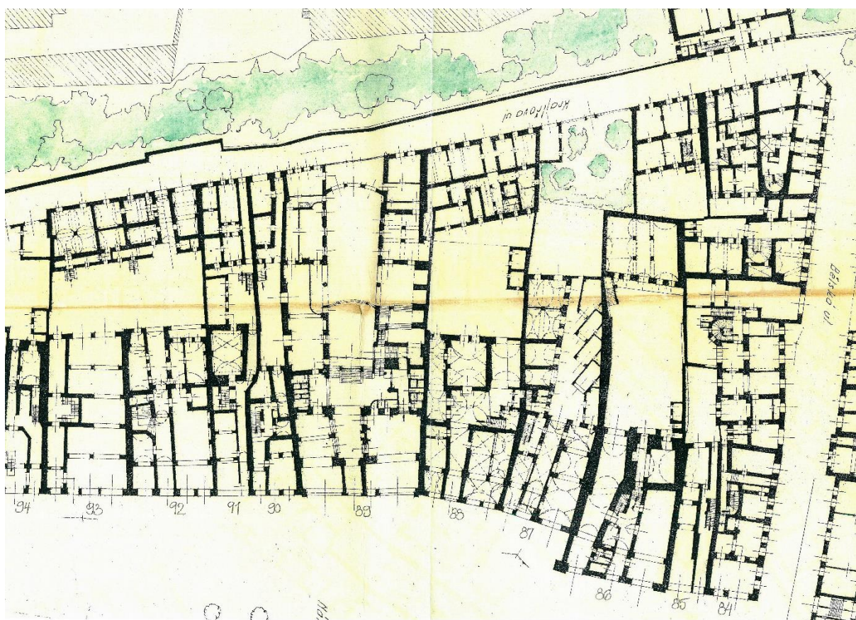
J. Košťák, zaměření Staroměstského náměstí, 1944 – 60, výřez severní strany s půdorysy přízemí domů čp. 84 - 94
