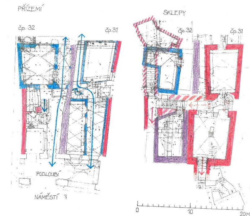
Půdorys přízemí a sklepů domů čp. 31 a 32 s vyznačením stavebních fází a komunikačních vazeb (s využitím zaměření shp, 1981).
