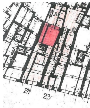
Půdorys přízemí domů čp. 23 a 24 s vyznačením půdorysu zadního sklepa červenou barvou (s využitím zaměření J. Košťáka)
