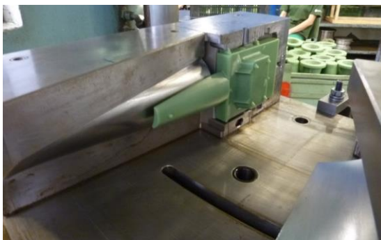
Obrázek 4.1 Umístění zálitku ve vstřikovací formě
