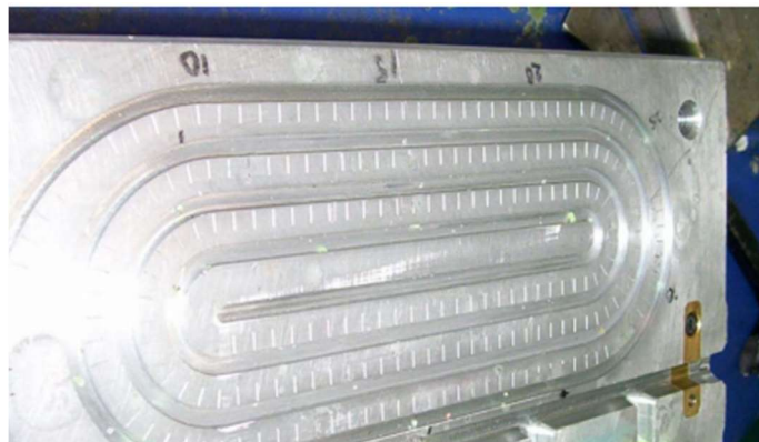
Obrázek 2.6. Forma pro zkoušku tekutosti vosku [7]
