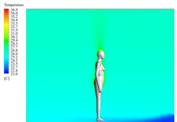
Obr. 166 Teplotní pole – případ D: 32,2 °C (R)
