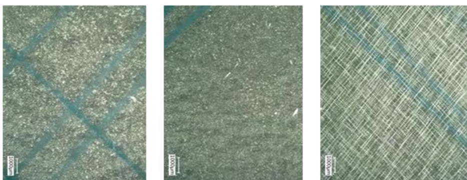
Obr. 4. - Detail povrchu matrice zkusebních těles se skladbou [(+45)J] po zatížení 5.10 6 cyklů na hladinách s horním smykovým napětím cyklu 16 MPa, 20 MPa a 25 MPa (zleva).
