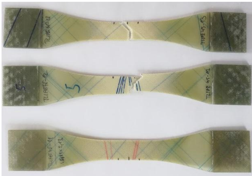
Obr. P1.5 – Zkušební tělesa použitá pro stanovení poklesu modulu pružnosti ve smyku na hladině zatížení s horním smykovým napětím cyklu 20 MPa a součinitelem asymetrie cyklu 0,1.
