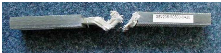
Obr. 2.11 - Zkušební těleso UD kompozitu sklo/epoxid poškozené v důsledku ztráty stability, hodnota součinitele asymetrie cyklu byla 10. Převzato z [47].
