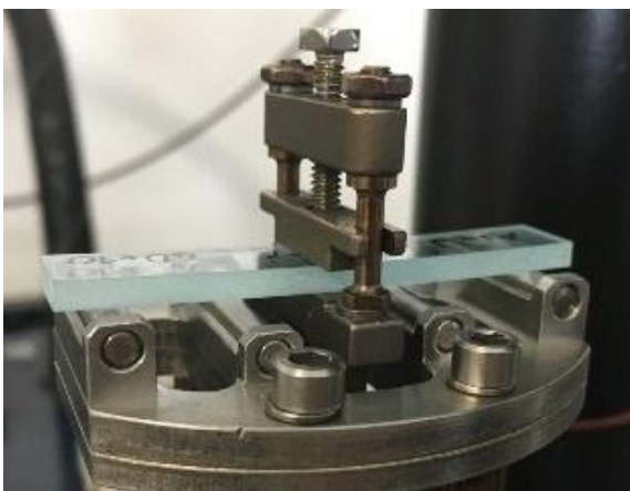
Obr. 5.15 - Detail upnutí zkušební tělesa ve stroji pro DMA analýzy v nástavci pro tříbodový ohyb
