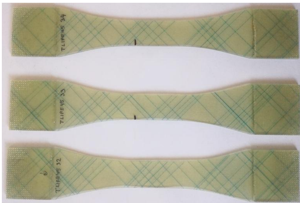
Obr. P1.7 - Zkušební tělesa použitá pro stanovení poklesu modulu pružnosti ve smyku na hladině zatížení s horním smykovým napětím cyklu 16 MPa a součinitelem asymetrie cyklu 0,1.
