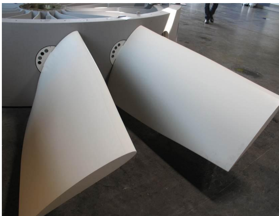
Obr. 1.1- Lopatky axiálního ventilátoru aerodynamického tunelu. Zdroj: Archiv VZLÚ
