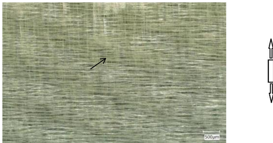
Obr. 5.22 - Detail povrchu zkušebního tělesa se skladbou [(0/90)_8] po zatížení 5 \cdot 10^5 cykly na hladinách s horním napětím cyklu 169 MPa a součinitelem asymetrie cyklu 0,1. Vedle obrázku je naznačeno schéma tahově zatíženého zkušebního tělesa, kde orientace snímku odpovídá orientaci tělesa v tomto schématu. Zvětšení je 50.
