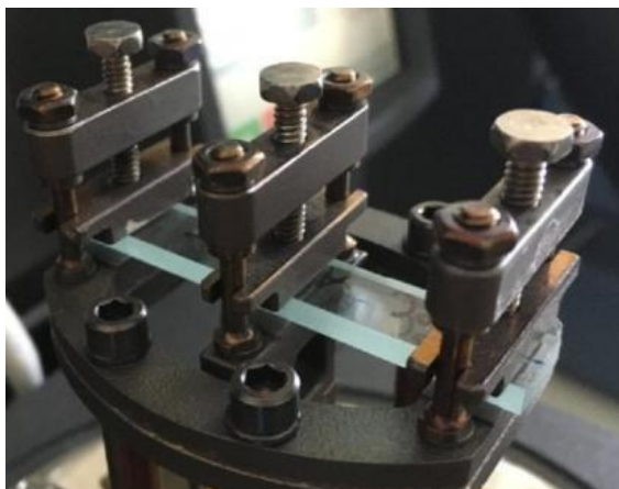
Obr. 5.12 - Detail způsobu upnutí zkušebního tělesa ve stroji pro DMA analýzy v nástavci „Dual Cantilever“
