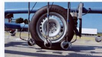
Obrázek 2: Detail na reálné umístění jednotlivých mikrotfonů okolo pneumatiky SRTT
