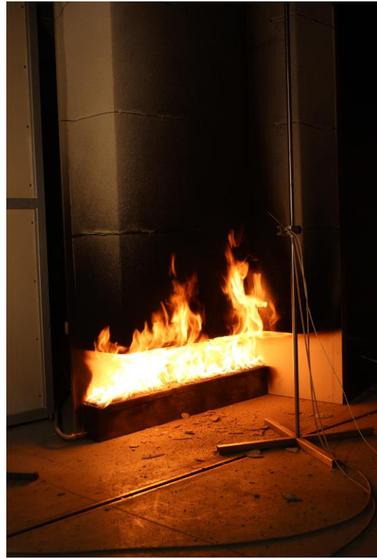
obr. 11: Zkouška dle ČSN ISO 13785-1
