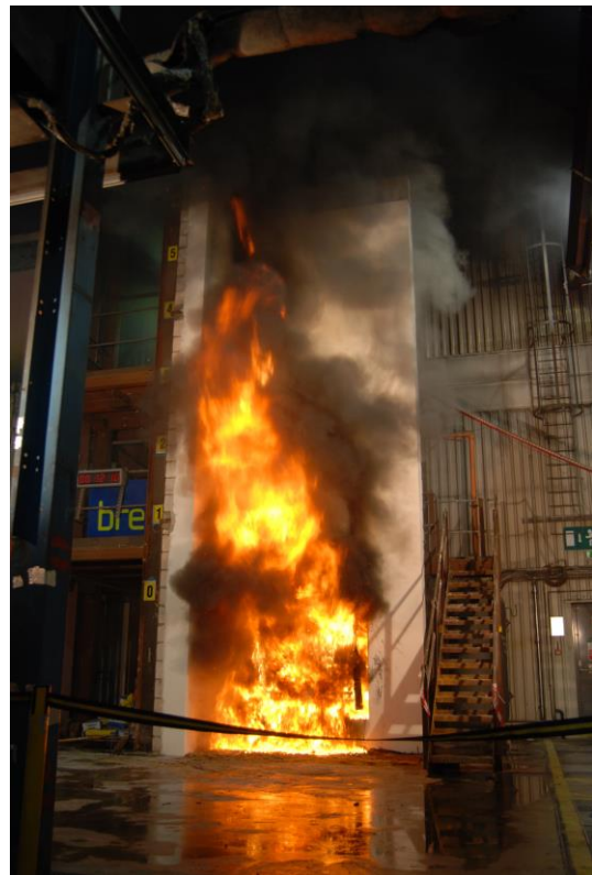
obr. 12: Zkouška velkého rozměru, konkrétně dle BS 8414-1 © M. Smolka
