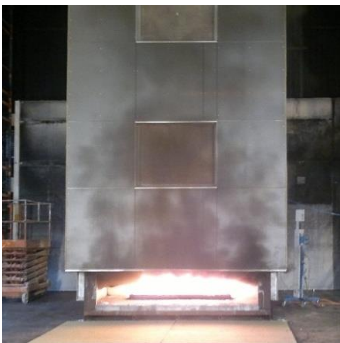
obr. 13: Zkouška dle ISO 13785-2 [45], foto vlevo © www.asb-portal.cz
