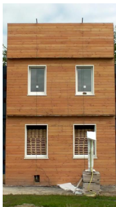
obr. 13: Zkouška dle ISO 13785-2 [45], foto vlevo © www.asb-portal.cz
