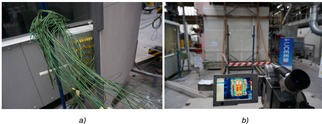
obr. 53: EnviLOP, měřicí zařízení: a) Zapojení termočlánků, b) Termovizní kamera
