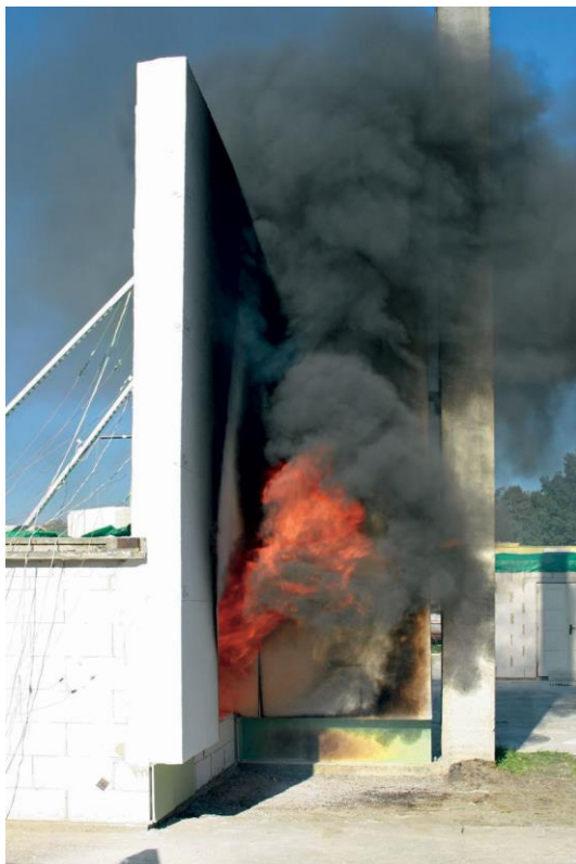
obr. 13: Zkouška dle ISO 13785-2 [45], foto vlevo © www.asb-portal.cz
