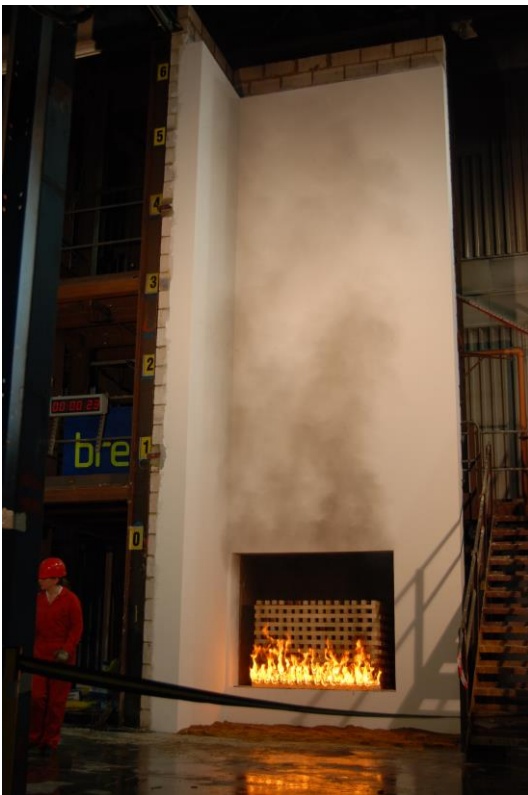
obr. 12: Zkouška velkého rozměru, konkrétně dle BS 8414-1 © M. Smolka
