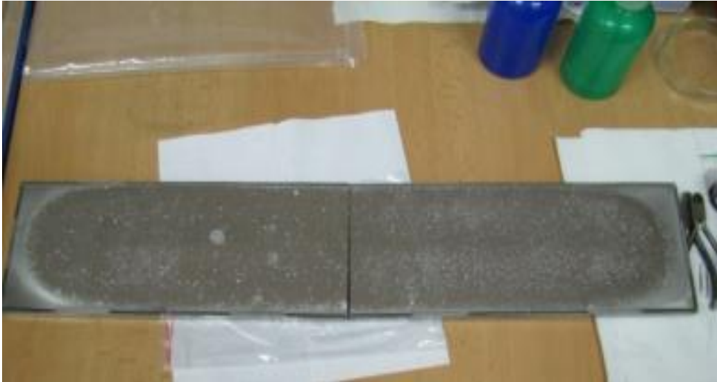
Obrázek 32: Target, ze kterého se odprašuje materiál.
