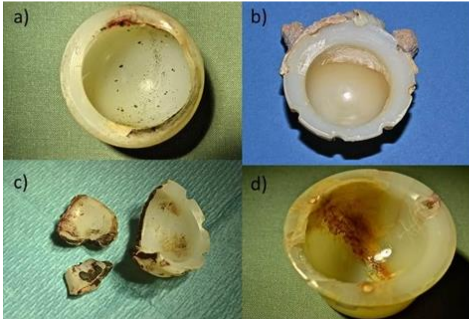
Obrázek 4: Poškození UHMWPE jamky náhrady kyčelního kloubu různými mechanismy otěru: a) adhezivní otěr, b) abrazivní otěr, c) otěr z přítomnosti třetího tělesa, d) únavový otěr (delaminace) [24].
