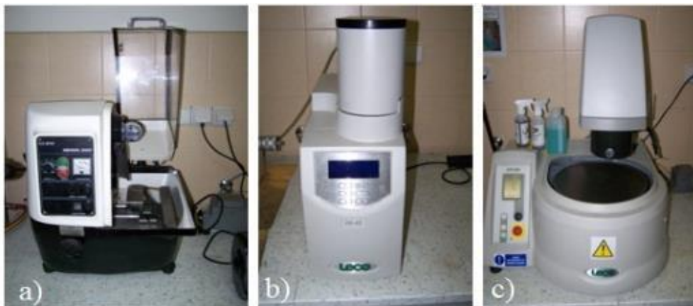
Obrázek 18:Přístroje pro přípravy povrchu vzorků: a) pila Mikron 3000 (MTH), b) metalografický lis LECO PR – 4x, c) bruska-leštička LECO GPX 300
