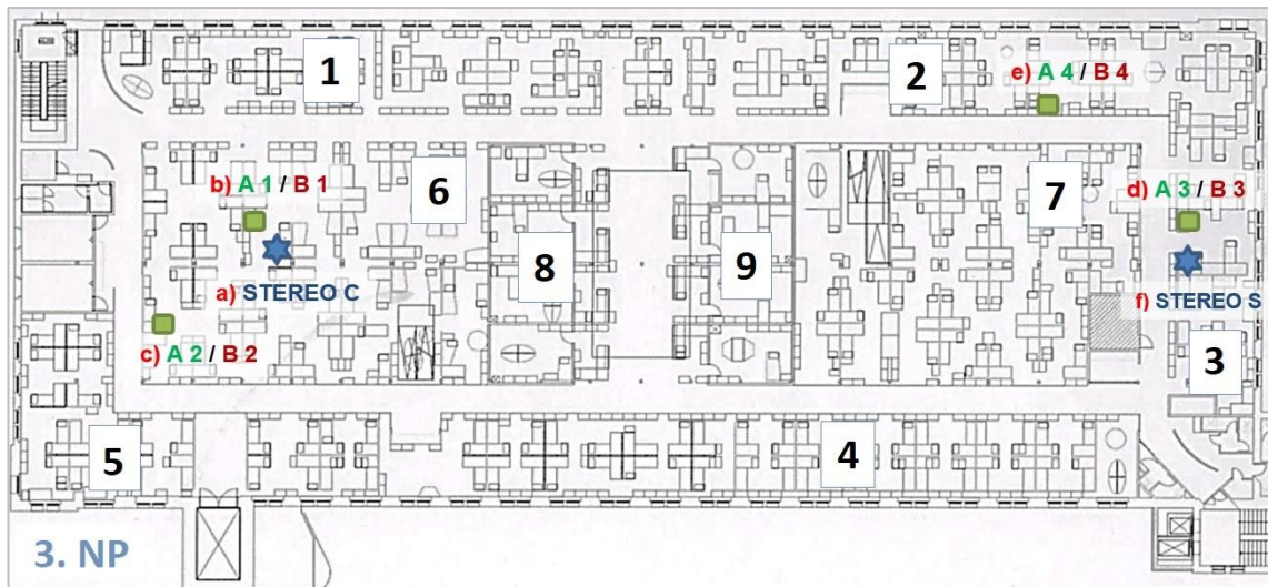
Obr. 46: Rozmístění měřicích přístrojů v zimním období ve 3. NP
