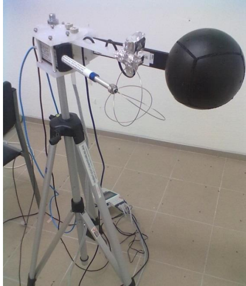
Obr. 4: Kulový stereoteploměr v sestavě se sondami pro měření suché teploty a rychlosti proudění vzduchu
