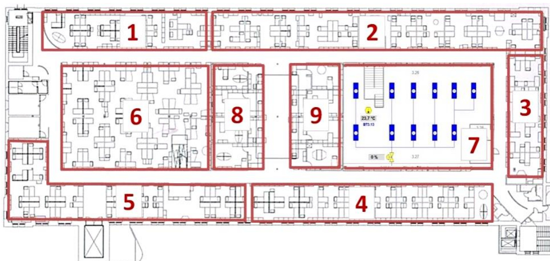
Obr. 42: Půdorys 3. NP s vyznačenými sekcemi CHIT (v sekci „7“ je vyznačeno schéma z jedné z regulovaných větví systému)
