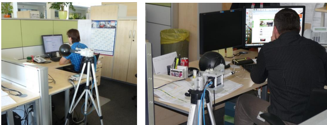
Obr. 44: Měření v blízkosti zaměstnanců a umístění sestavy čidel se stereoteploměrem
