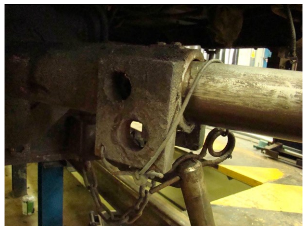
Obrázek 26 – detail zajištění teleskopického spřáhla [3]
