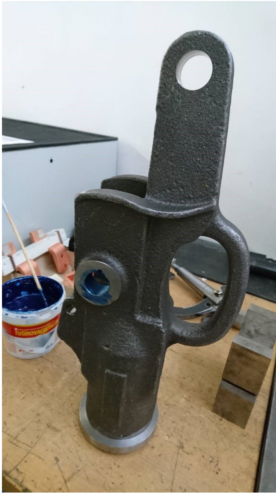
Obrázek 32 – odlitek spřahovací hlavy Albert [3]
