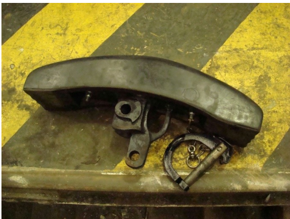
Obrázek 25 – ochrana spřáhla v provozu [3]
