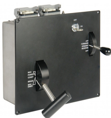
Obrázek 4 - Kontrolér pro metro Delhi (Indie)
