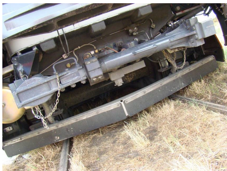
Obrázek 19 – složené spřáhlo s pantem [3]
