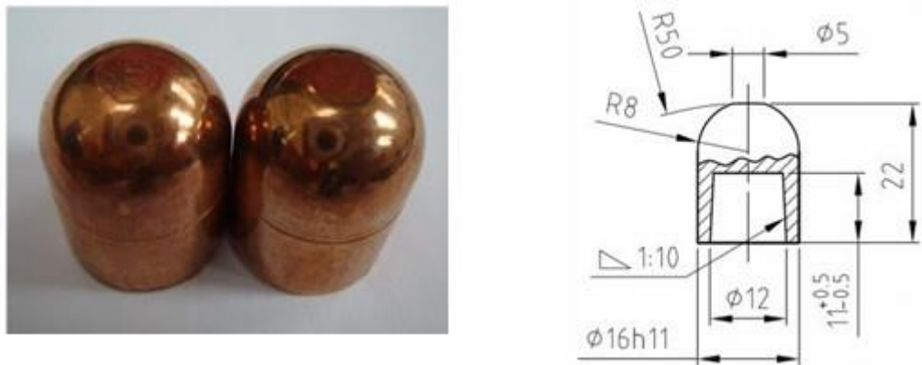
Obr. 31 Výkres elektrodové čepičky typ 39D 1978-2, \varnothing 5 mm [48]
