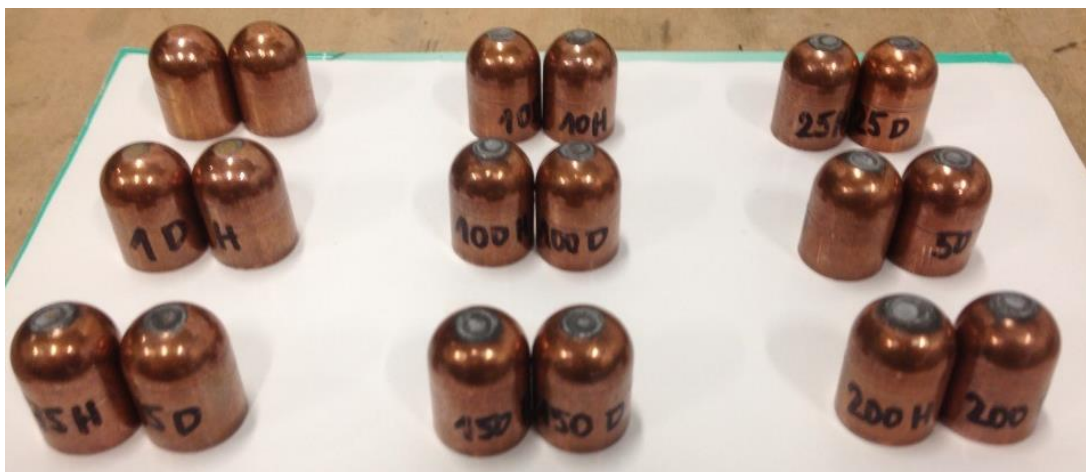
Obr. 35 Vyrobené opotřeбенé elektrodové čepičky
