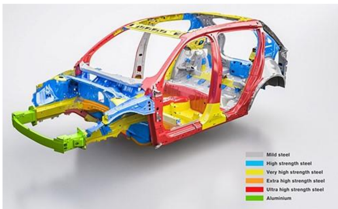
Obr. 30 Konstrukce karoserie Volvo XC40, 2018 [22]
