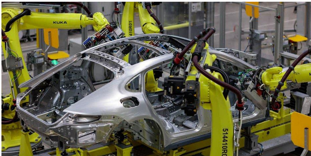
Obr. 26 Roboty kontrolují karoserii sportovního vozu Panamera v továrně Porsche [45]
