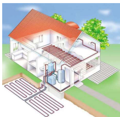
Obrázek 8 – Tepelné čerpadlo - kolektor
