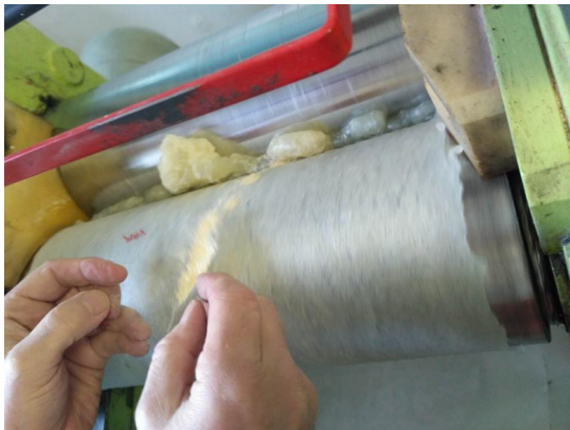
Obrázek A.1: Obohacování izoprenu o zinkovou sůl Foto: autor
