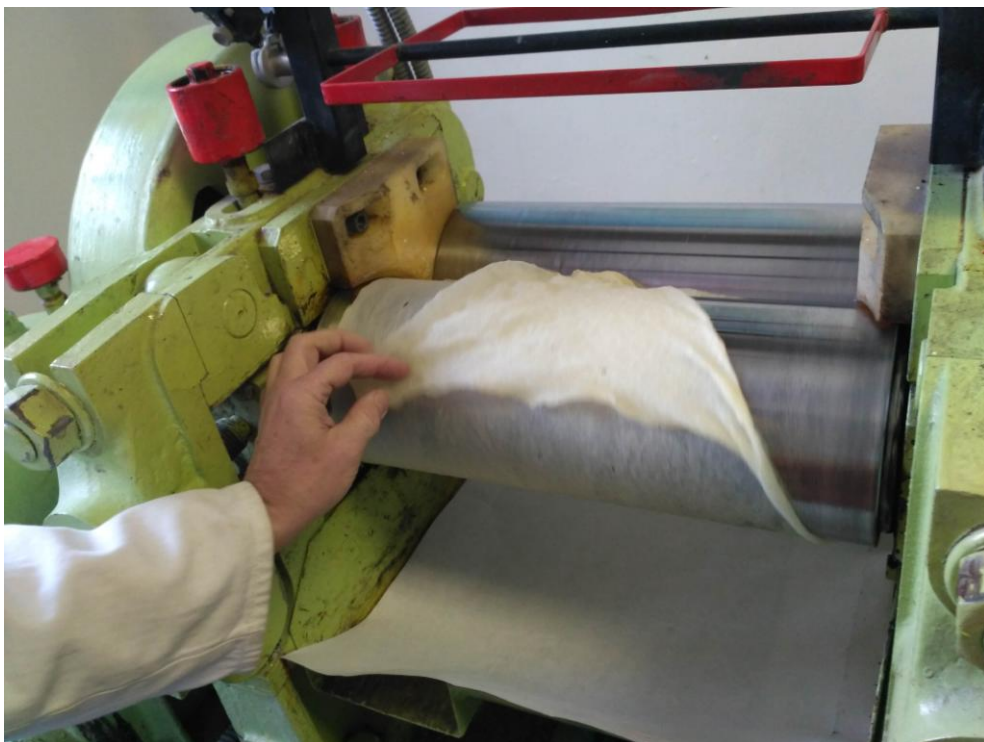
Obrázek A.4: Křížení isoprenu sloužící k zajištění homogenního rozložení aditiv
