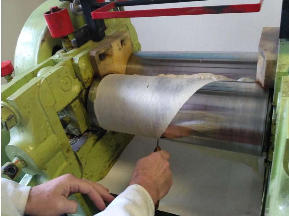
Obrázek A.3: Nařezávání elastomeru za účelem jeho křížení Foto: autor
