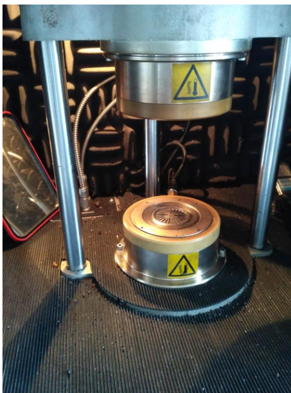
Obrázek 2.2: Vulkametr v laboratoři VŠCHT (Fotografie: autor)
