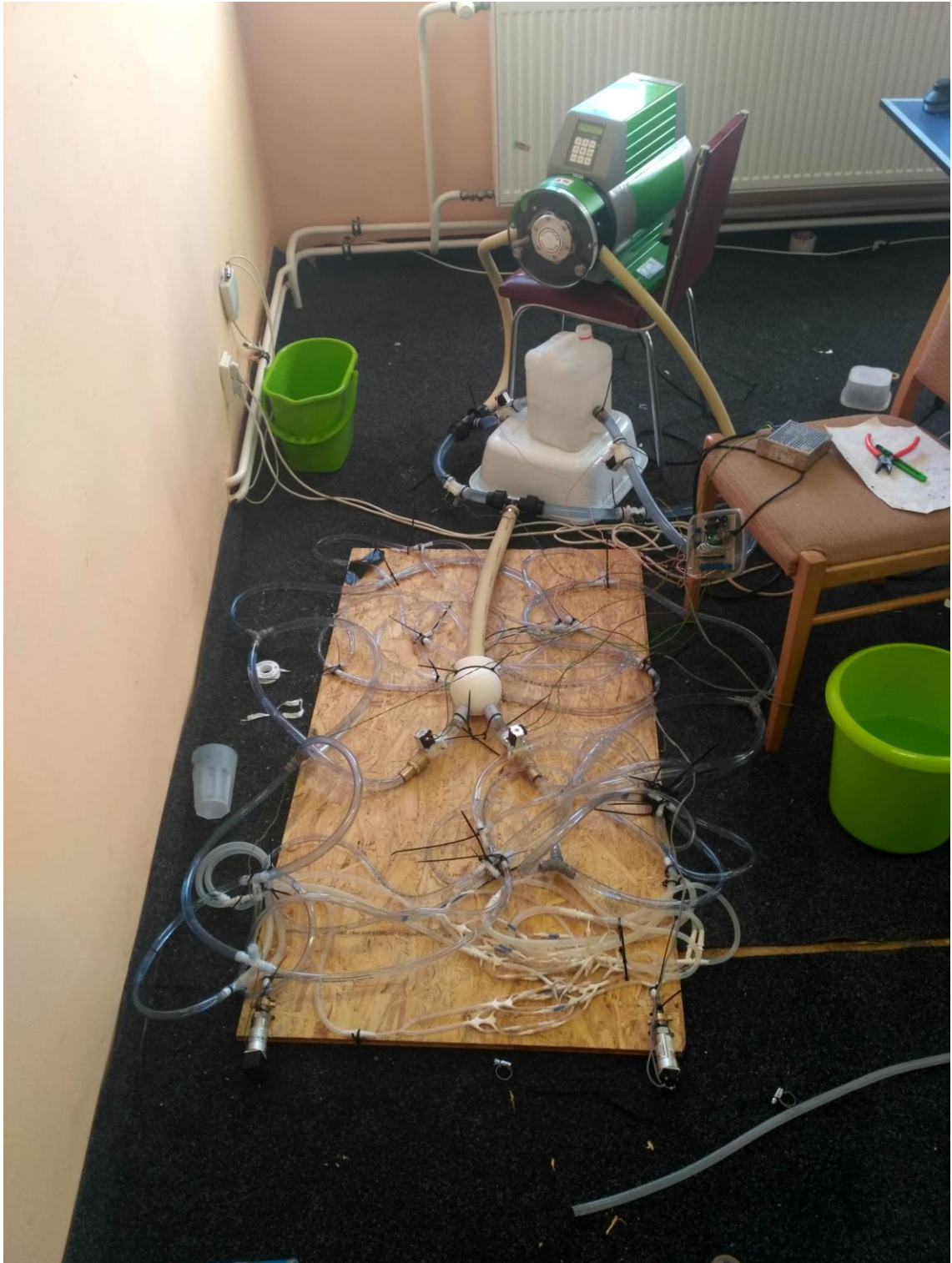
Obrázek C.1: Ukázka měření tlaku v pulzatilním režimu v horizontální poloze Foto: autor
