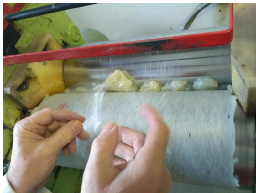
Obrázek A.2: Obohacování izoprenu o urychlovač Foto: autor
