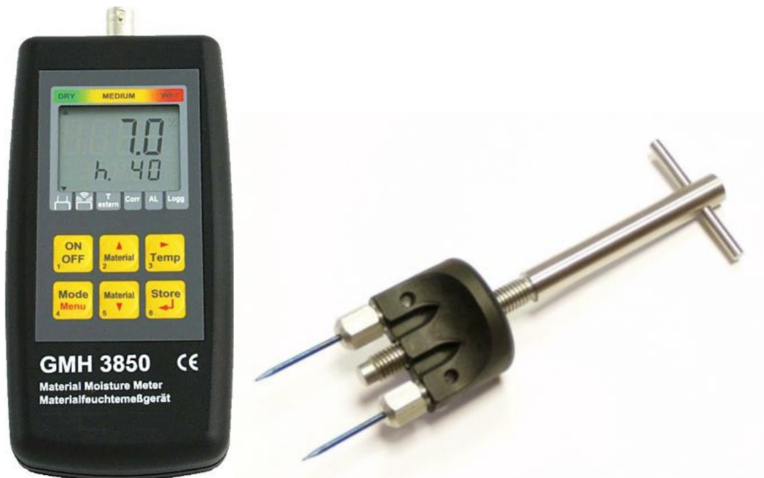
Obrázek 37: Odporový vlhkoměr GHM 3850
