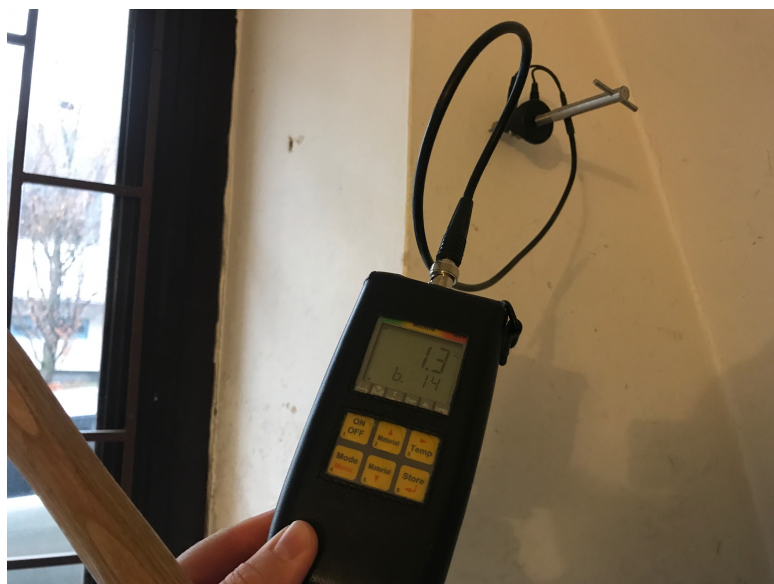
Obrázek 39: Měření ve horní části obvodového zdiva z interiéru
