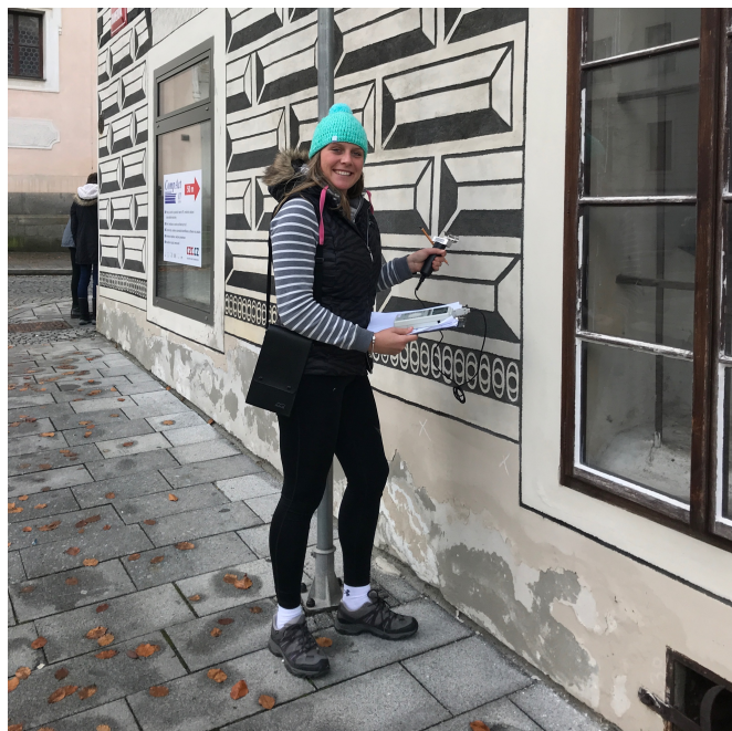
Obrázek 36: Měření v terénu příložným kapacitním vlhkoměrem
