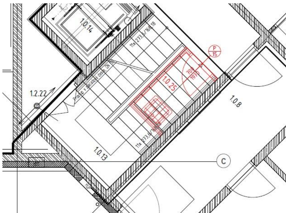
Obr. 2: Nové úklidové místnosti pod schodištěm
