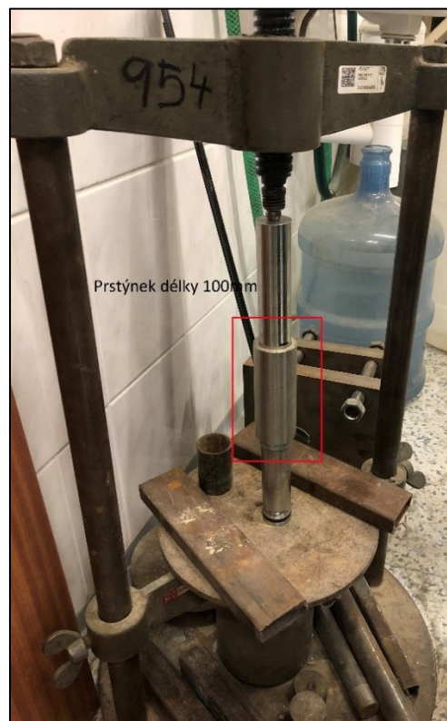
Obr. 17 Lisování vzorku do prstýnku
