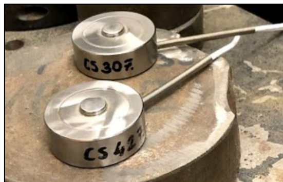
Obr. 7 Silové čidlo snímající napětí v propustoměru
