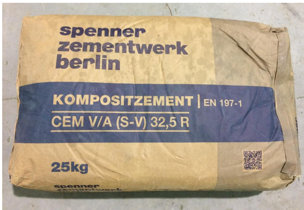
Obr. č. 25 - Cement použitý pro výrobu cementové suspenze
