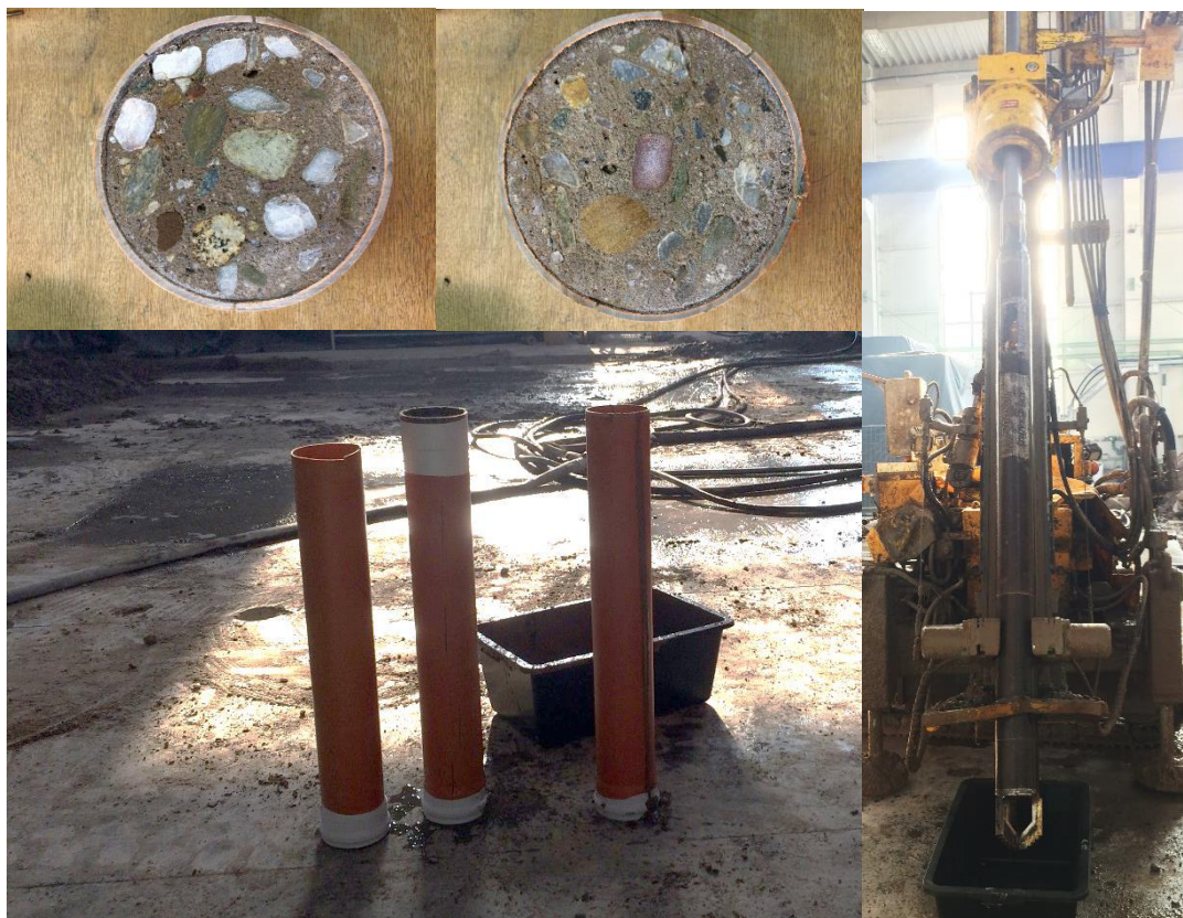
Obr. č. 20 - Přeříznuté vzorky obsahující zrna nevyhovující velikosti, odebrané vzorky, odběrný válec namontovaný na vrtné soupravě
