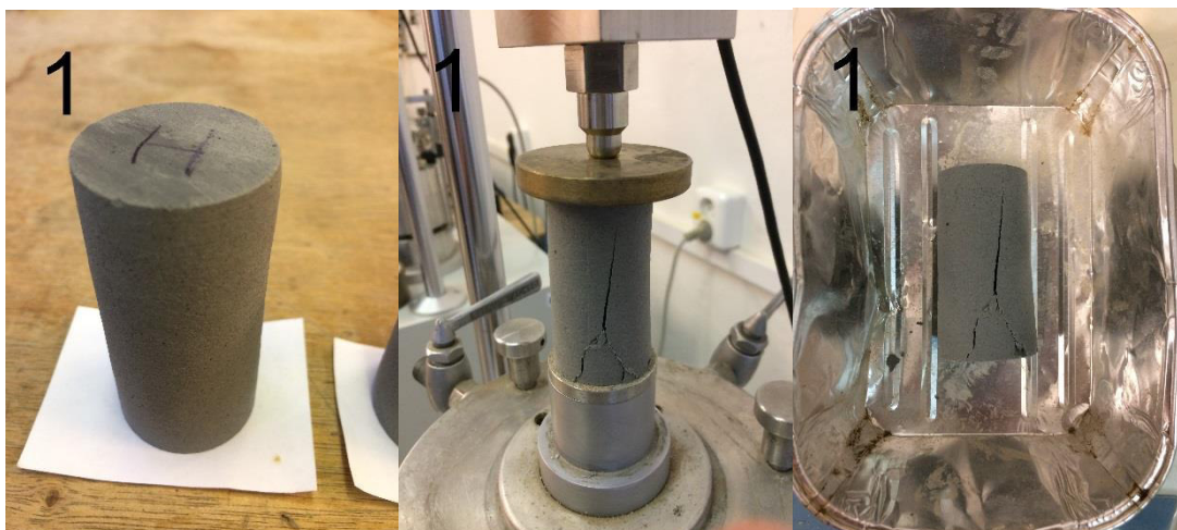
Obr. č. 36 - Vzorek č. 1 před a po zkoušce
