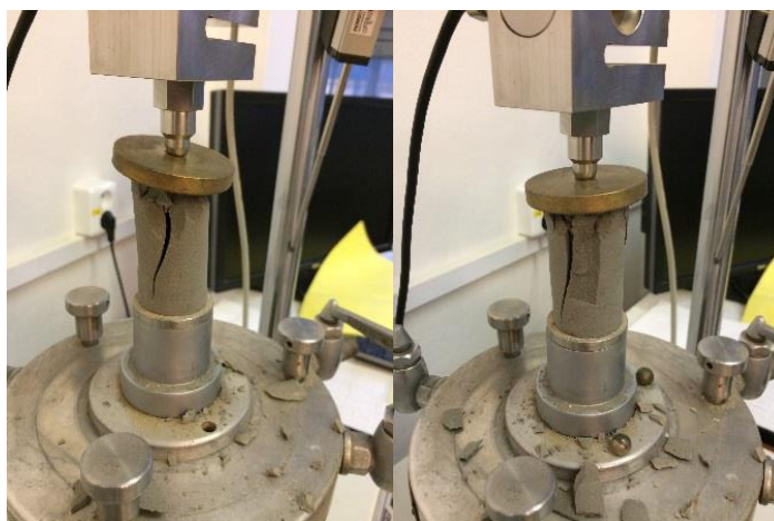
Obr. č. 29 - Porušení vzorků, zleva č. 1 a 2
