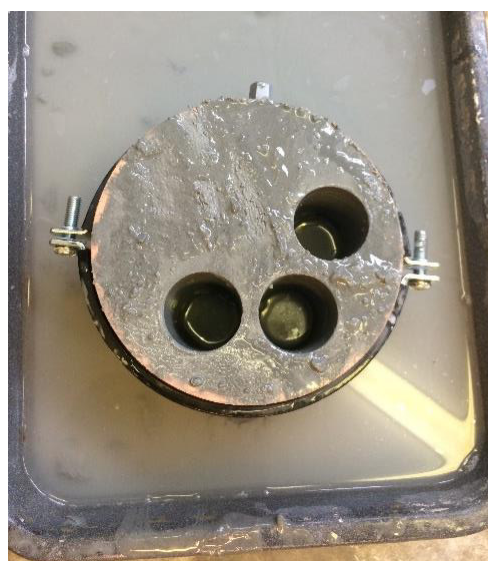
Obr. č. 33 - Válcové těleso odříznuté z trubky s otvory po vyvrtaných jádrech
