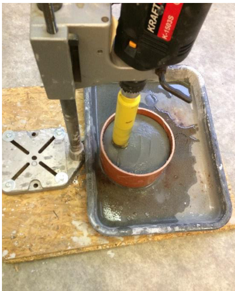
Obr. č. 35 - Způsob vrtání vzorků. Vrtačka, stojan, vrtací jádrová korunka, válec se zatvrdlou suspenzí
