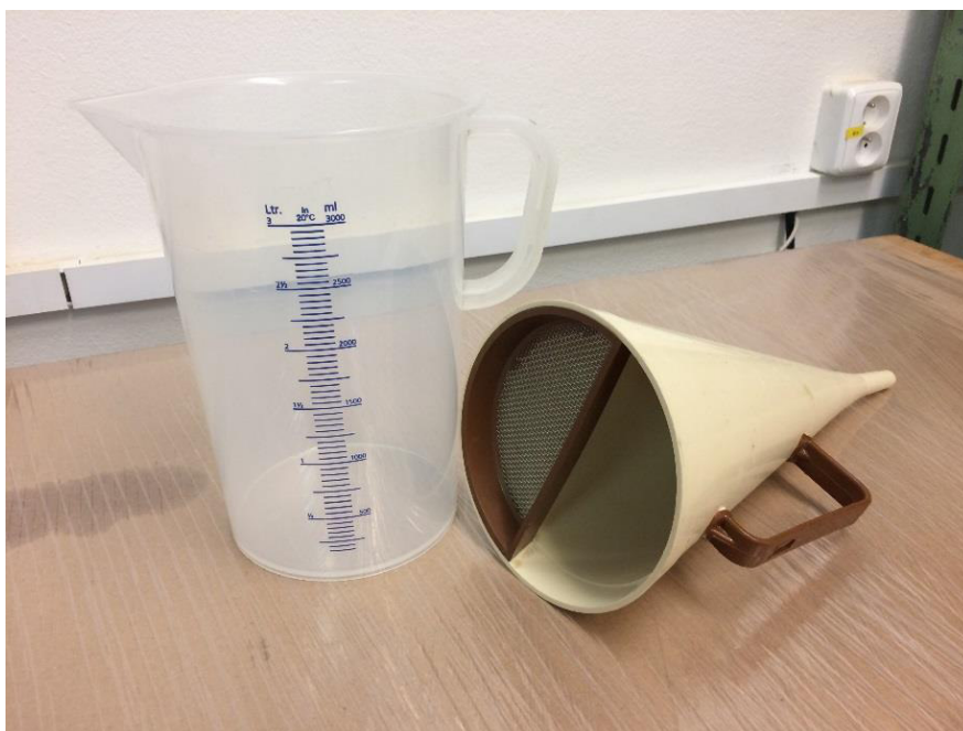
Obr. č. 23 - Marshův trychtýř a odměrný válec použité pro zkoušení
