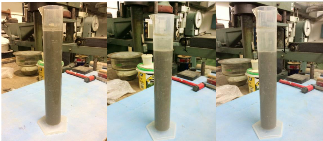
Obr. č. 21 - Odměrný válec s cementovou suspenzí po odlití, po 2 hodinách a po 3 hodinách
