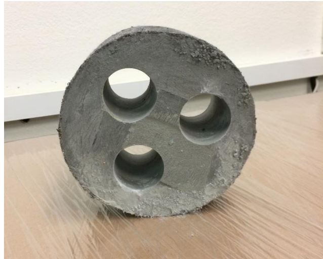
Obr. č. 54 - Otvory po odvrtaných vzorcích
