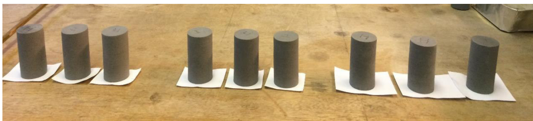
Obr. č. 34 - Vyvrtané upravené vzorky před zkouškou pevnosti (zleva č. 1-9)
