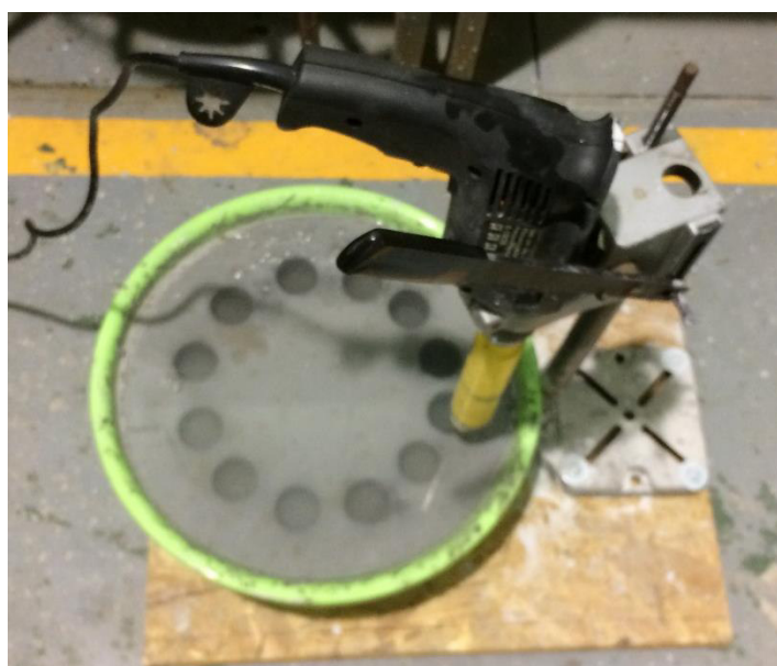
Obr. č. 63 - Lavor s otvory po odvrtných zkušebních vzorcích (po 7 a 14 dnech)
