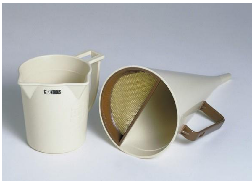
Obr. č. 16 - Marshův trychtýř s odměrkou. Obrázek převzat z [7]
