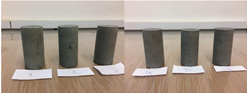
Obr. č. 46 - Vzorčky před zkouškou v tlaku
