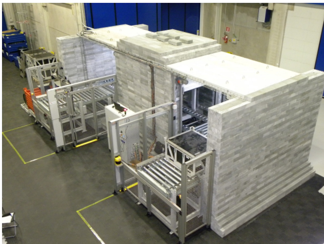
Obrázek 6.2: Uvažovaný systém stínění s obchodním názvem NuRad8200 od firmy NUVIA. Jedná se aktuálně o do značné míry unikátní systém na bázi betonové stavebnice a suchého zdění s případným kotvením. [40]
