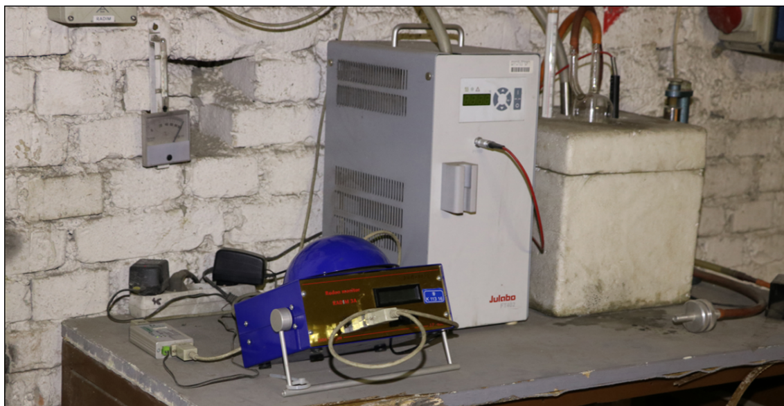
Obrázek 4.12: Stacionární přístroj na monitorování radonu v ÚRAO Richard [31]
