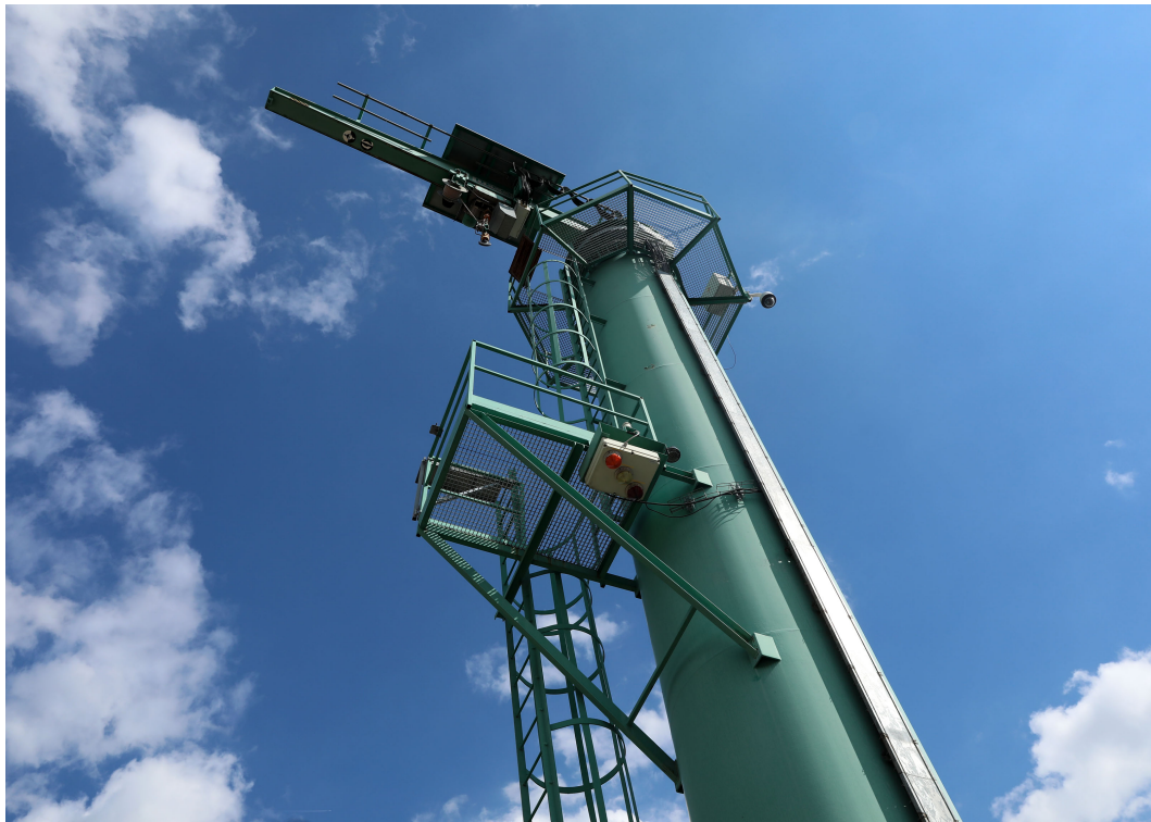
Obrázek 4.13: Sloupový jeřáb, který je využíván pro pádové zkoušky. [32]
