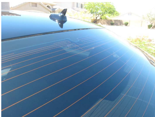
Obr. 5.4 – Lokální ohřev zadního prosklení [27]
