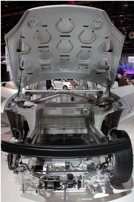
Obr. 4.8 – Hliníková karoserie elektromobilu Tesla [22]
