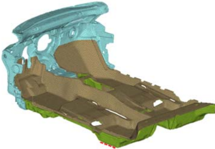
Obr. 4.4 – Příčka mezi přední nápravou a palubní deskou [6]
