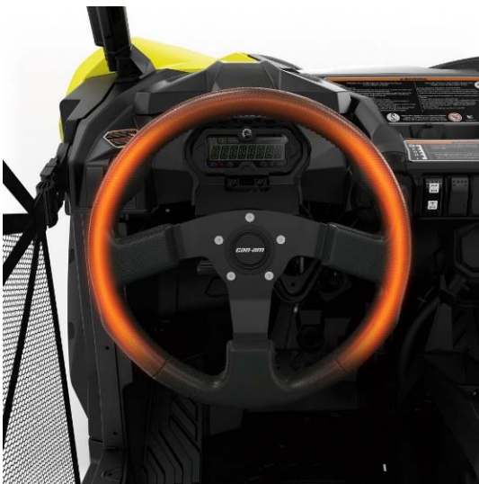
Obr. 5.6 – Lokální ohřev volantu [28]
