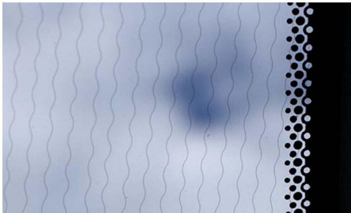
Obr. 5.3 – Lokální ohřev čelního skla automobilu [27]
