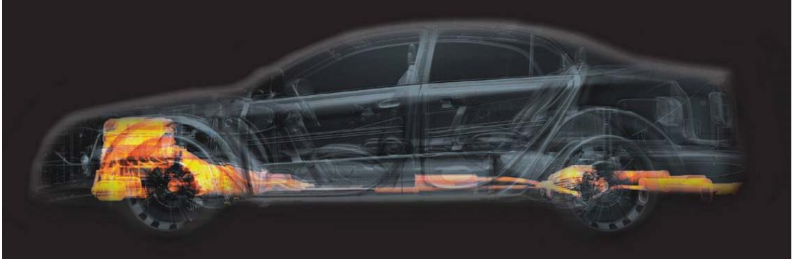
Obr. 3.2 – Znárodnění spalovacího agregátu a pohonu které jsou pro danou karoserii tepelnými zisky [3]
