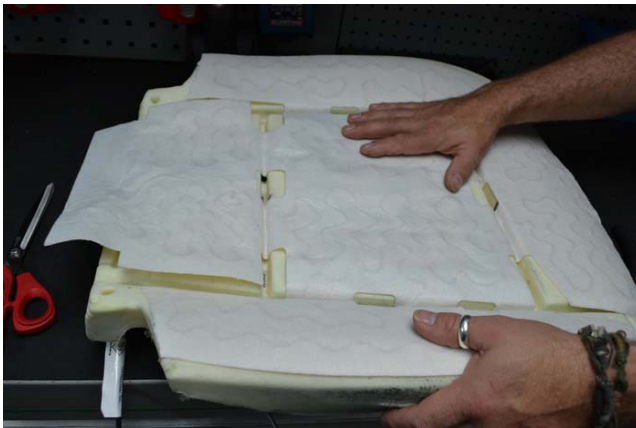
Obr. 5.5 – Lokálně vyhřívaná spodní část sedadla [25]
