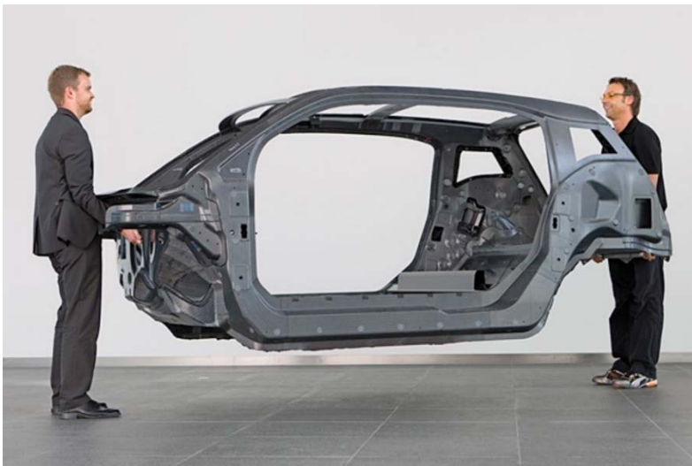
Obr. 4.7 – Karoserie BMW i3 bez vnějších dílů [4]
