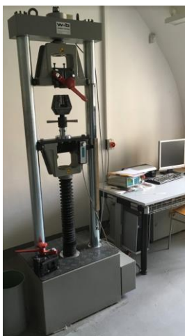
Obr. 26 Fotografie použitého trhacího stroje ZD 10 Walter.
