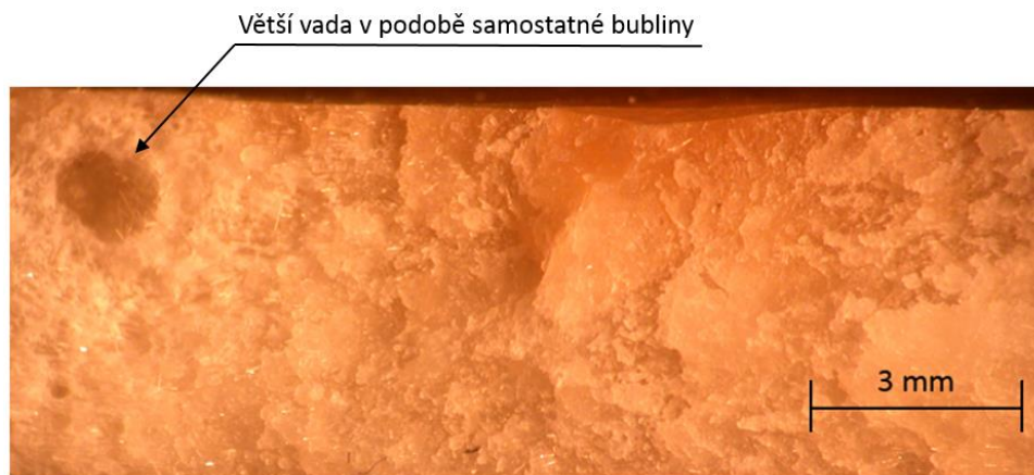
Obr. 29 Vzorek s 20 % skelných vláken
