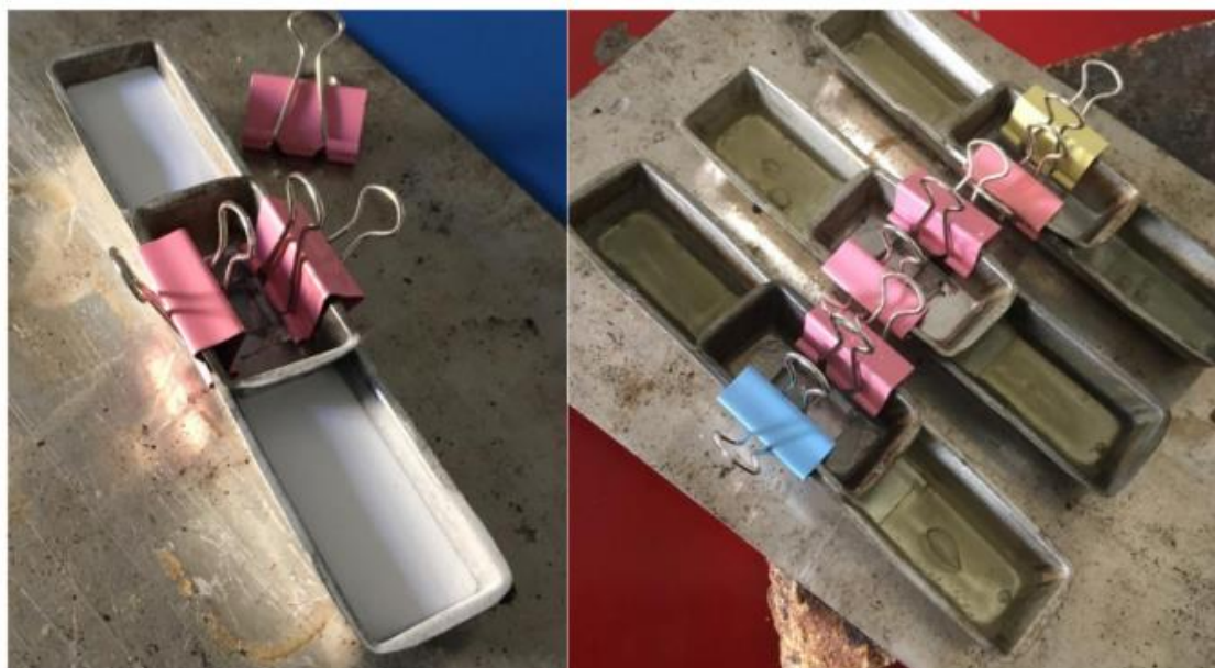
Obr. 22 Nová forma (vlevo) na vzorky se sklíčkem před vložením do pece a nové formy (vpravo) těsně po vytažení z pece.
