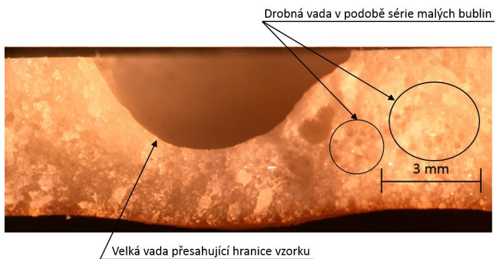
Obr. 30 Vzorek s 30 % skelných vláken a střední vadou v podobě bubliny
