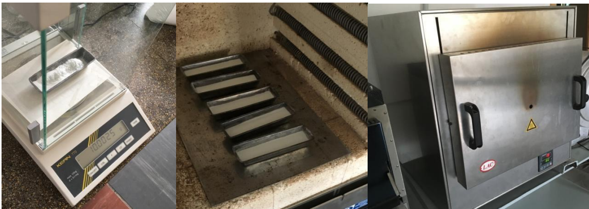
Obr. 24 Na obrázku vlevo můžete vidět fázi přípravy vzorků za pomoci váhy a formy. Uprostřed můžete vidět fázi přípravy vzorků, kdy jsou vzorky připraveny v peci. Vpravo můžete vidět pec, pro pečení vzorků.
