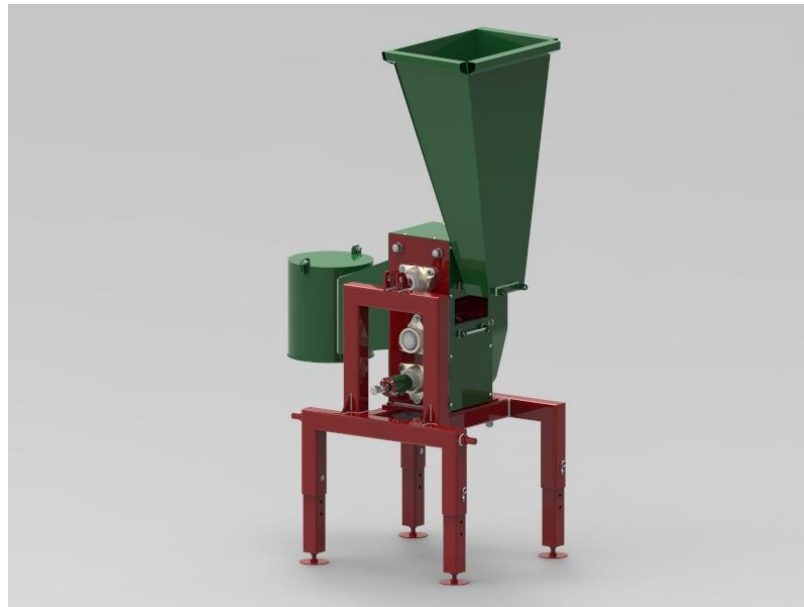
Obr. 30.: Špalíkovač – přepravní poloha násypky
