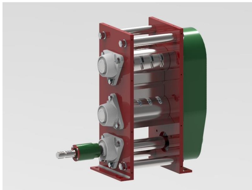
Obr. 40.: Mechanismus s plechovým krytem ozubených kol
