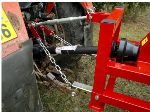
Obr. 5.: Propojení pomocí kardanové hřídele [5]
