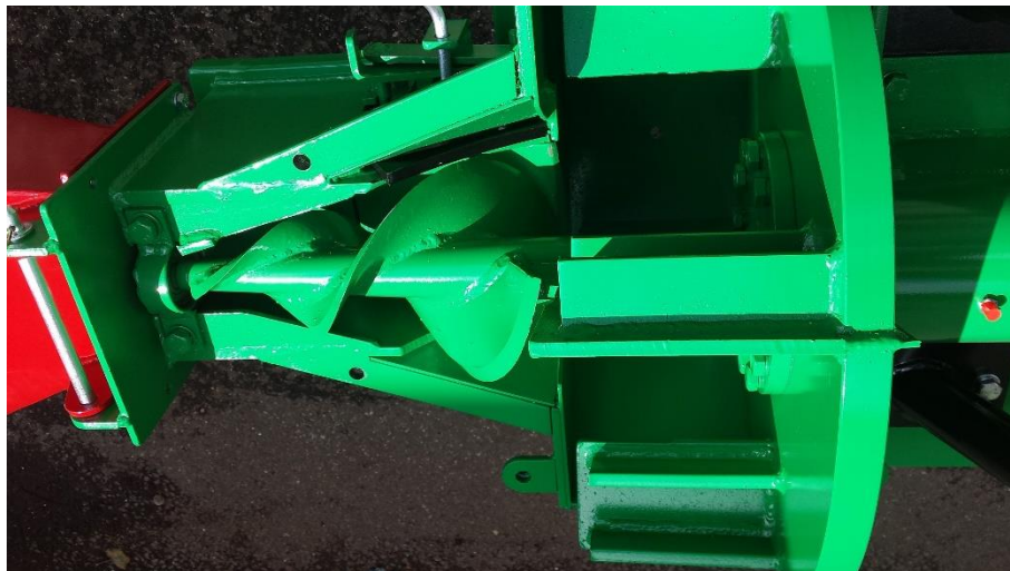
Obr. 1.: Kónický šroubový břit [1]
