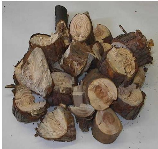
Obr. 4.: Špalíky děleny pomocí rotorů s břity [2]
