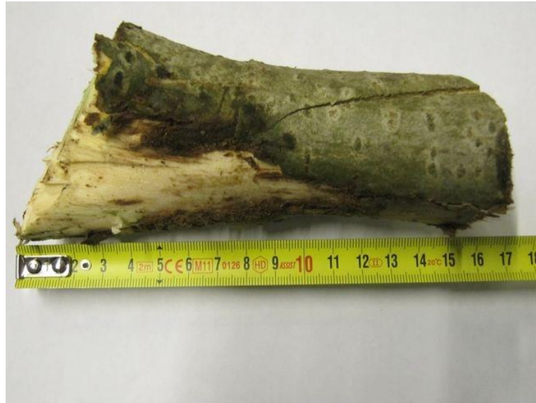
Obr. 2.: Špalík oddělen pomocí šroubového břitu [1]
