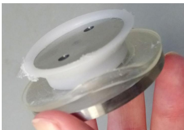
Obr. 59 Detail zdeformovaného kotevního bodu vzorku S1-02
