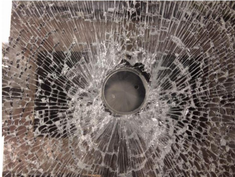
Obr. 34 Detail vzorku po tahové zatěžovací zkoušce [8]
