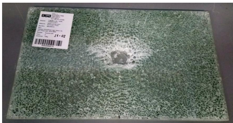
Obr. 58 Vzorek S1-02 po porušení
