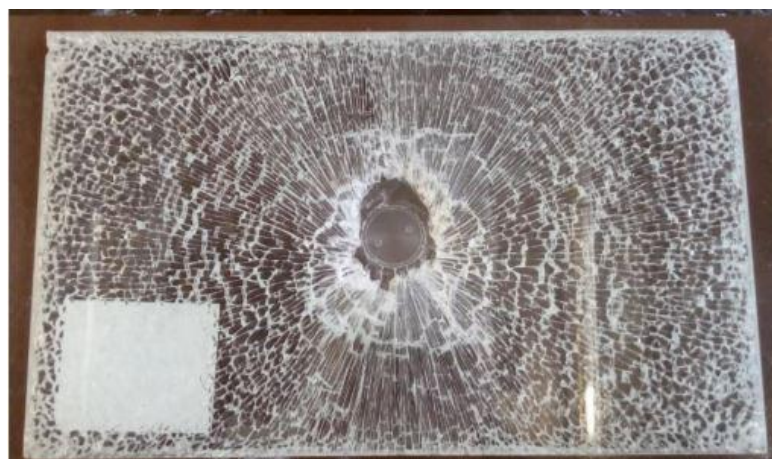
Obr. 36 Vzorek po tahové zatěžovací zkoušce [10]
