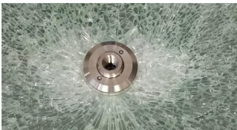
Obr. 54 Detail tvrzeného skla vzorku S1-01 po porušení
