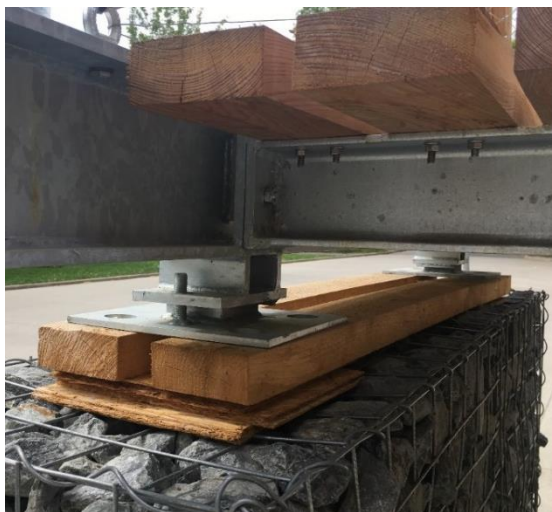
Obrázek 5.5 Pohled na uložení konstrukce v době provádění experimentu
