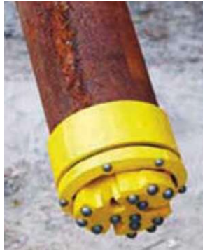
Obrázek 19: Pažnicová korunka 114,3 mm a vrtná korunka ponorného kladiva systému zavlékané pažnice Symmetrix z roku 2000 [5]
