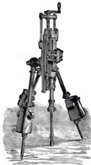
Obrázek 16: Lehká pneumatická vrtačka podle patentu S. Ingersolla z roku 1871 [4]
