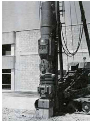
Obrázek 5: Dlouhodobě nejpoužívanější typ těžkého dieselberanu – Delmag D55 [2]
