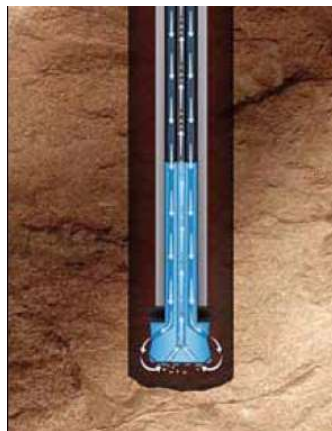
Obrázek 20: Princip ponorného kladiva s reverzní cirkulací v dvouplášťové pažnici, znázorněný švédskou firmou Drconeq, konec 20. století [5]
