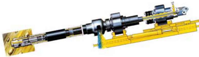
Obrázek 18: Schéma vrtného systému Duplex [5]
