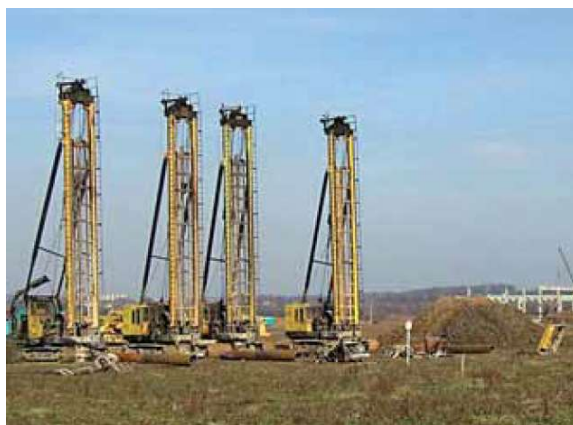
Obrázek 7: Pilotážní soupravy Franki používané ještě dnes v ČR [2]
