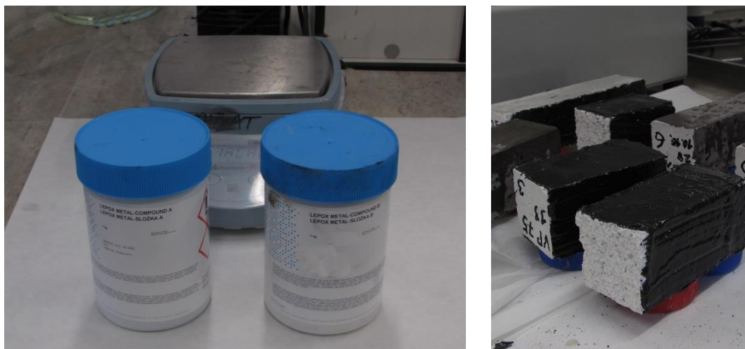
Obr. 17: Vlevo: LEPOX METAL – složka A a B, vpravo: vzorky po nanesení vrstvy epoxidu
