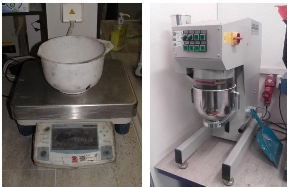
Obr. 8: Vlevo: vážení kameniva do záměsi, vpravo: míchání záměsi v míchačce
