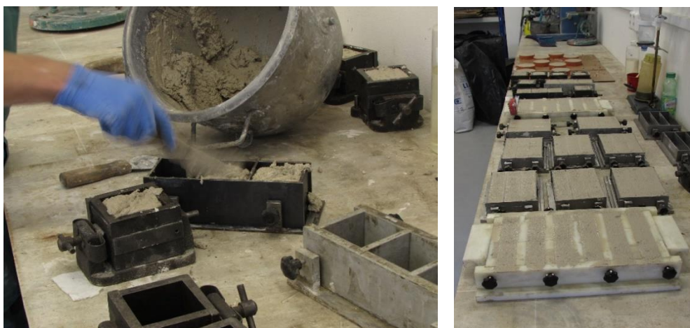
Obr. 9: Vlevo: plnění forem čerstvou maltovou směsí; vpravo: vzorky před odbedněním
