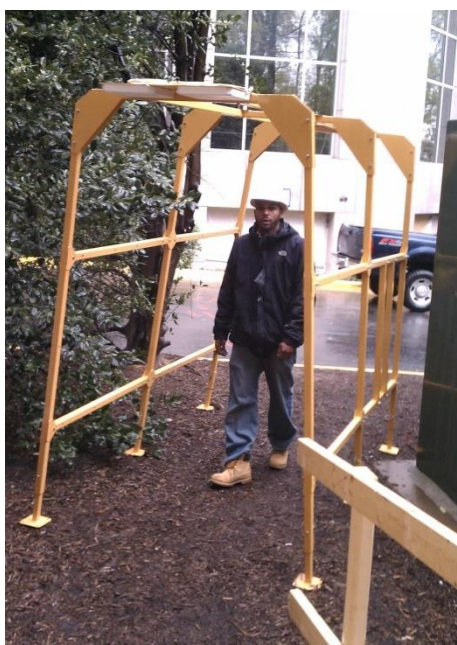
Obr. 18: RFID brána načítající UHF štítky z ochranné přilby pracovníka [36]
