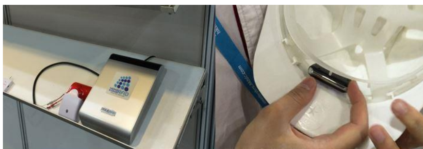
Obr. 23: Čtečka s připojeným alarmem (vlevo), štítek v ochranné přilbě (vpravo) [37]
