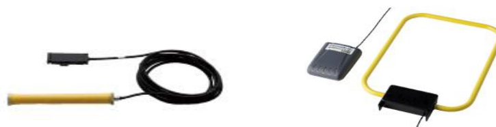
Obr. 24: Štítek s tenzometrem (vlevo) a čtečka s anténou (vpravo) [42]
