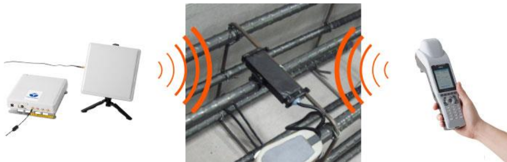
Obr. 26: Počítačem řízená čtečka s externí anténou (vlevo) a ruční čtečka (vpravo), štítek a senzor připevněný na výztužném prutu (uprostřed) [43]
