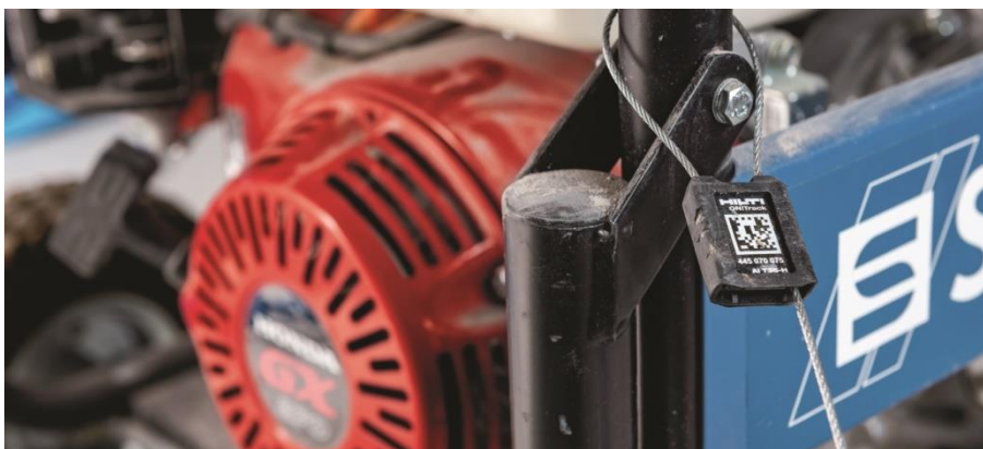
Obr. 19: NFC štítek na kleci benzínového generátoru elektrického proudu [38]
