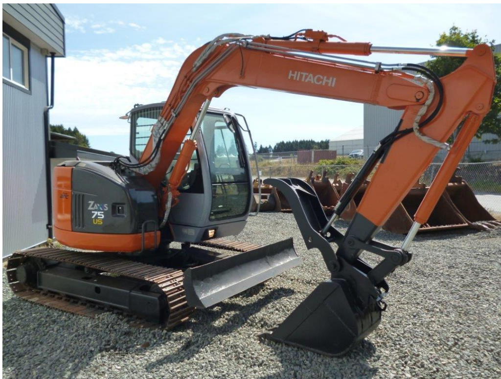
Obr1.: Pásové rypadlo pro výkop základových pasů [1]
