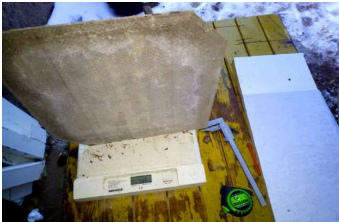
Obr. 21: Vážení vzorku nedegradované azbestocementové hladké šablony [archiv autora]
