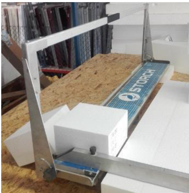
Obr. 18: Řezání vzorků EPS pomocí odporové řezačky
