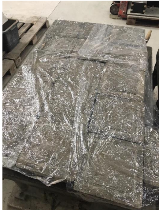
Obrázek 29 - Překrytí vzorků fólií na 24 hodin pro zabránění vysušování
