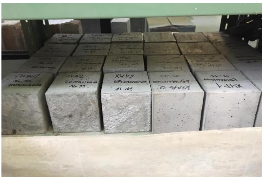
Obrázek 35 - Vzorky uložené v běžném prostředí laboratoře
