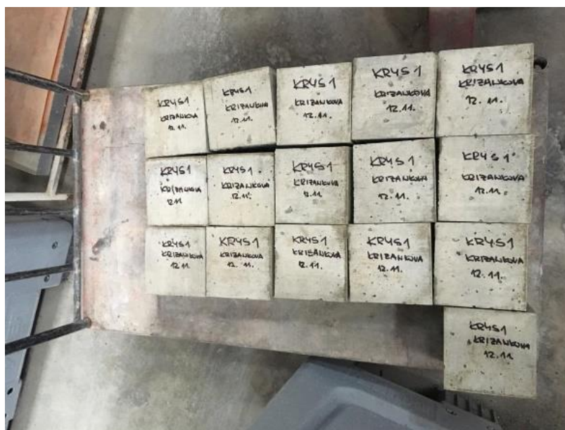
Obrázek 32 - Popsané vzorky KRYŠ 1, připravené na uložení do rozdílných prostředí
