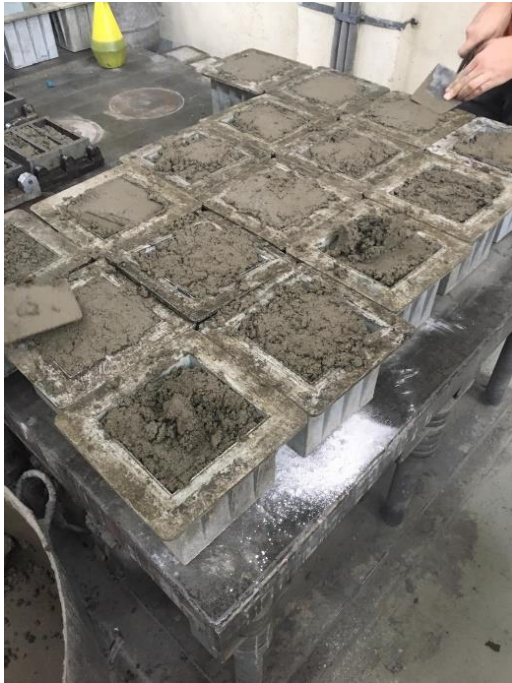
Obrázek 28 – Betonáž záměsi KRYŠ 1 do plastových krychlových forem uložených na vibračním stole
