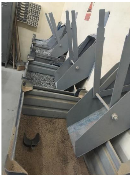
Obrázek 11 - použité kamenivo rozdělené dle frakcí
