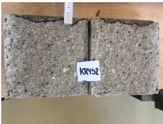
Obrázek 50 - Průsak tlakovou vodou KRY52
