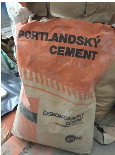
Obrázek 10 - použitý portlandský cement CEM I 42,5 R
