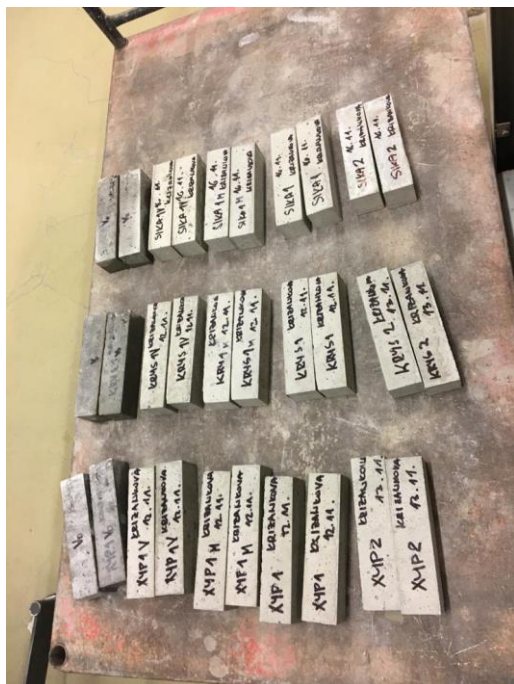
Obrázek 44 - Připravené trávce pro měření pevnosti v tahu ohybem
