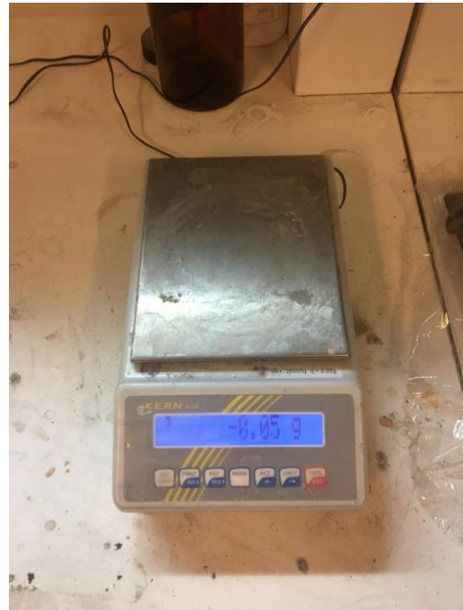
Obrázek 14 - Laboratorní váha Kern 572
