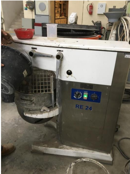
Obrázek 16 - Použitá míchačka pro záměs 20 l
