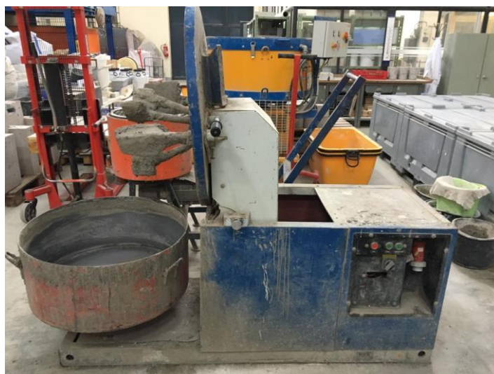
Obrázek 15 - Použitá míchačka pro záměs 75 l
