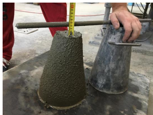
Obrázek 41 - Měření hodnoty sednutí kužele záměsi SIK4 1–40 mm
