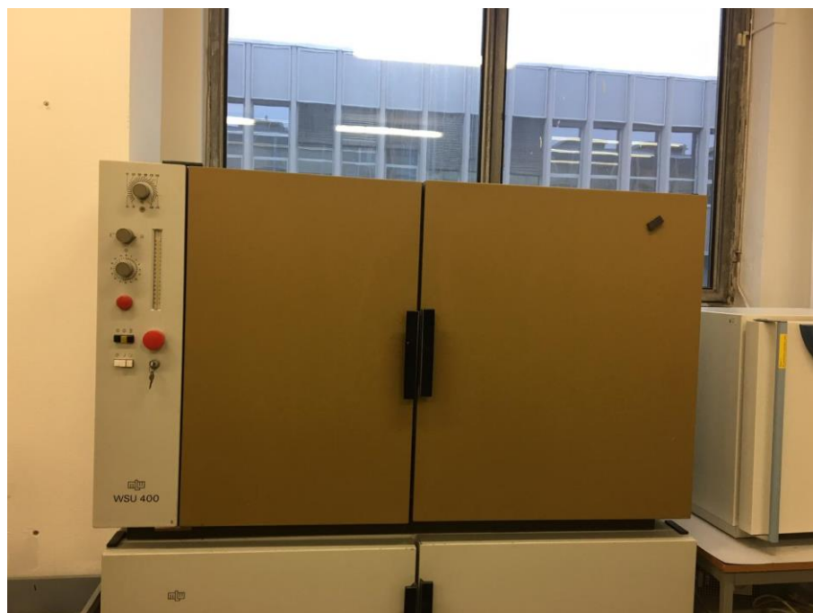
Obrázek 61 - Použitá sušárna WSU 400
