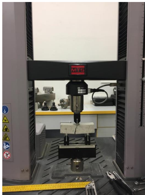
Obrázek 45 - Trávce v době porušení
