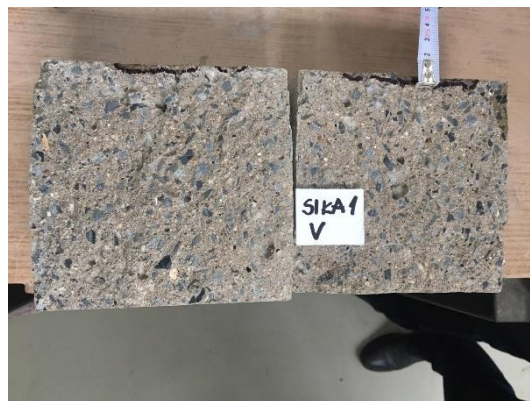
Obrázek 57 - Průsak tlakovou vodou SIKAI-vlhko
