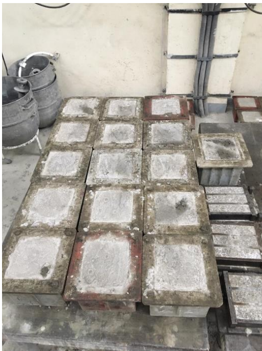
Obrázek 30 - Vzorky SIKKA 1 po 24 hodinách od betonáže připravené na odbedňování
