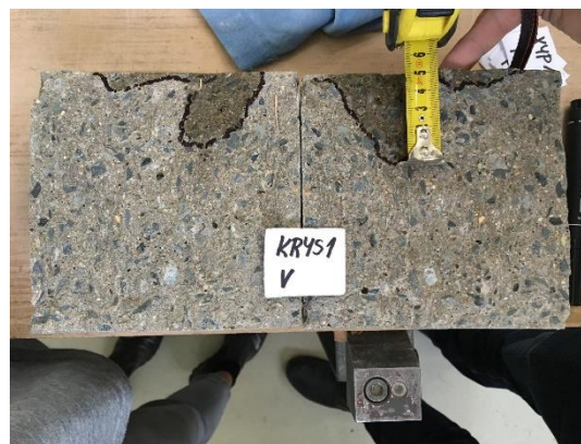
Obrázek 47 - Průsak tlakovou vodou KRYSI-vlhko
