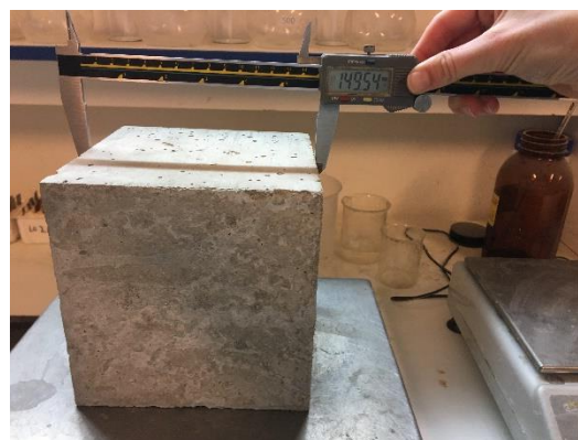
Obrázek 43 - Měření přesných rozměrů vzorků
