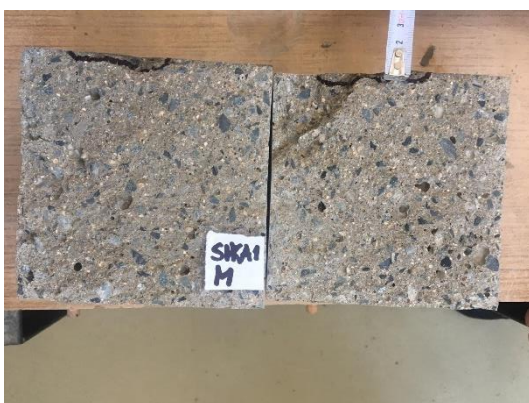
Obrázek 58 - Průsak tlakovou vodou SIKAI-mráz
