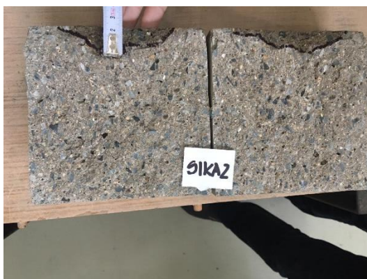
Obrázek 60 - Průsak tlakovou vodou SIKAI2
