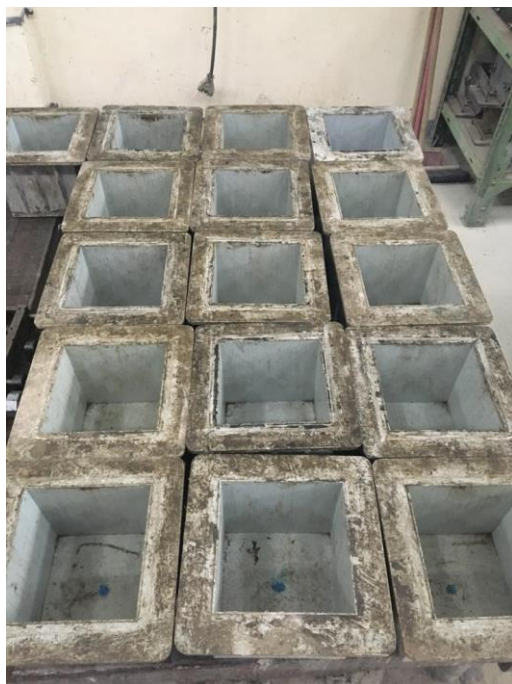
Obrázek 19 - plastové formy – krychle a=150\text{ mm}
