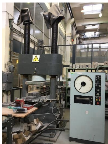
Obrázek 21 - Zatěžovací lis EDB 400 s maximální možnou silou v tlaku do 4000 kN
