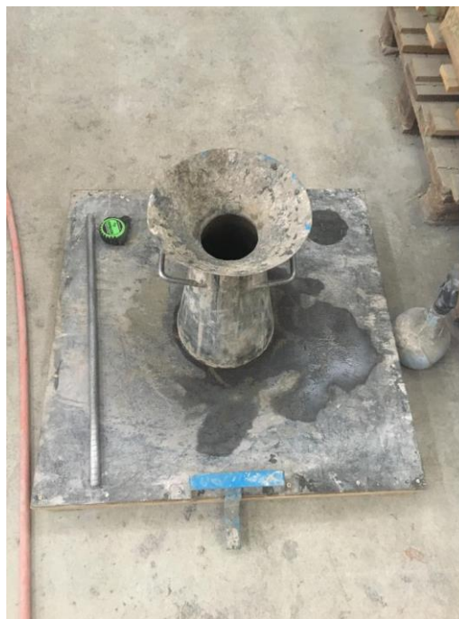
Obrázek 20 - Vybavení na zkoušku sednutí kužele
