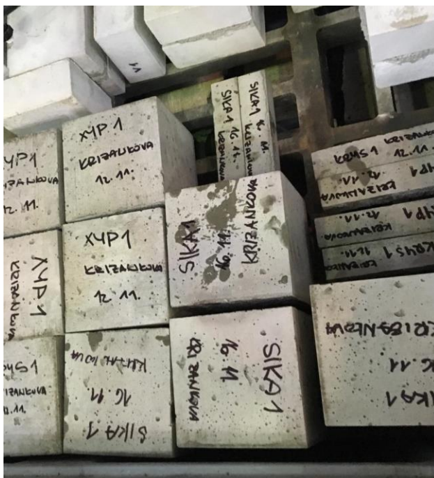
Obrázek 34 - Vzorky uložené na roštu ve vlhku
