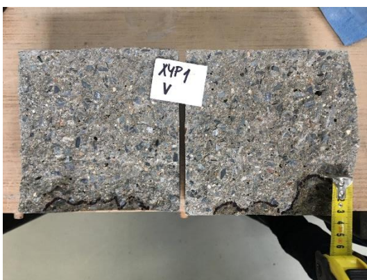
Obrázek 52 - Průsak tlakovou vodou XYP1-vlhko
