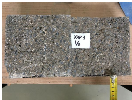
Obrázek 51 - Průsak tlakovou vodou XYP1-voda
