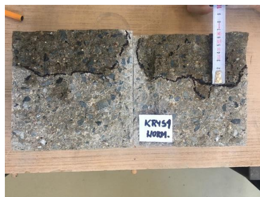
Obrázek 49 - Průsak tlakovou vodou KRYSI-běžné (neuvažovaný výběžek – otisk mokrého prstu)
