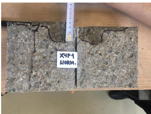
Obrázek 54 - Průsak tlakovou vodou XYP1-běžné
