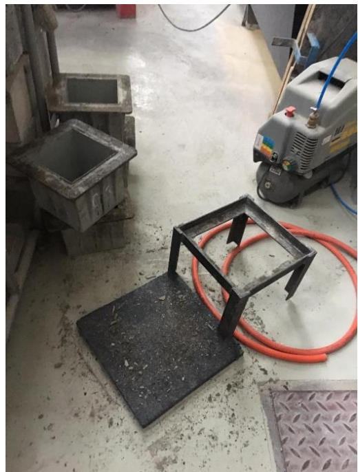
Obrázek 31 - Pomůcky na odbedňování vzorku z plastových forem
