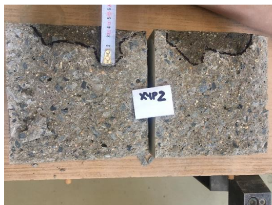
Obrázek 55 - Průsak tlakovou vodou XYP2
