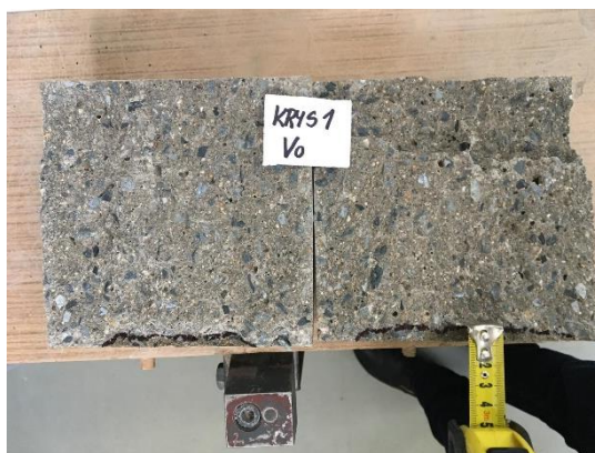
Obrázek 46 - Průsak tlakovou vodou KRYSI-voda
