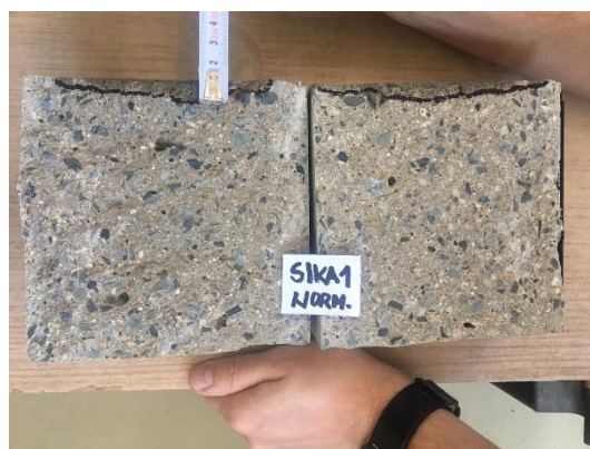
Obrázek 59 - Průsak tlakovou vodou SIKAI-běžné
