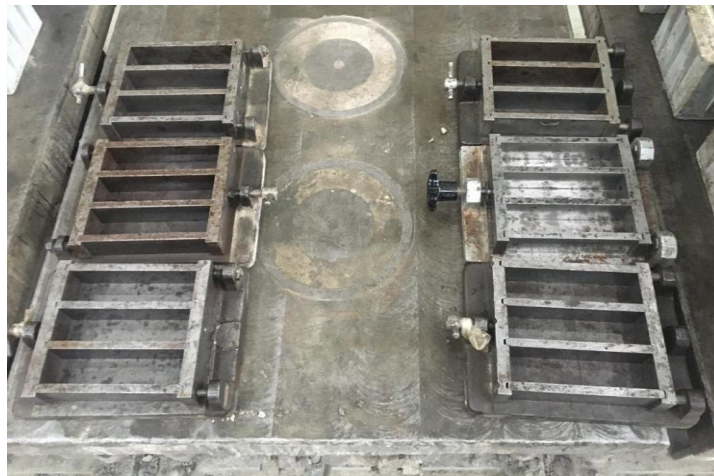
Obrázek 18 - Ocelové formy – trámce 40x40x160 mm
