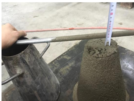
Obrázek 40 - Měření hodnoty sednutí kužele záměsi XYP 1–28 mm
