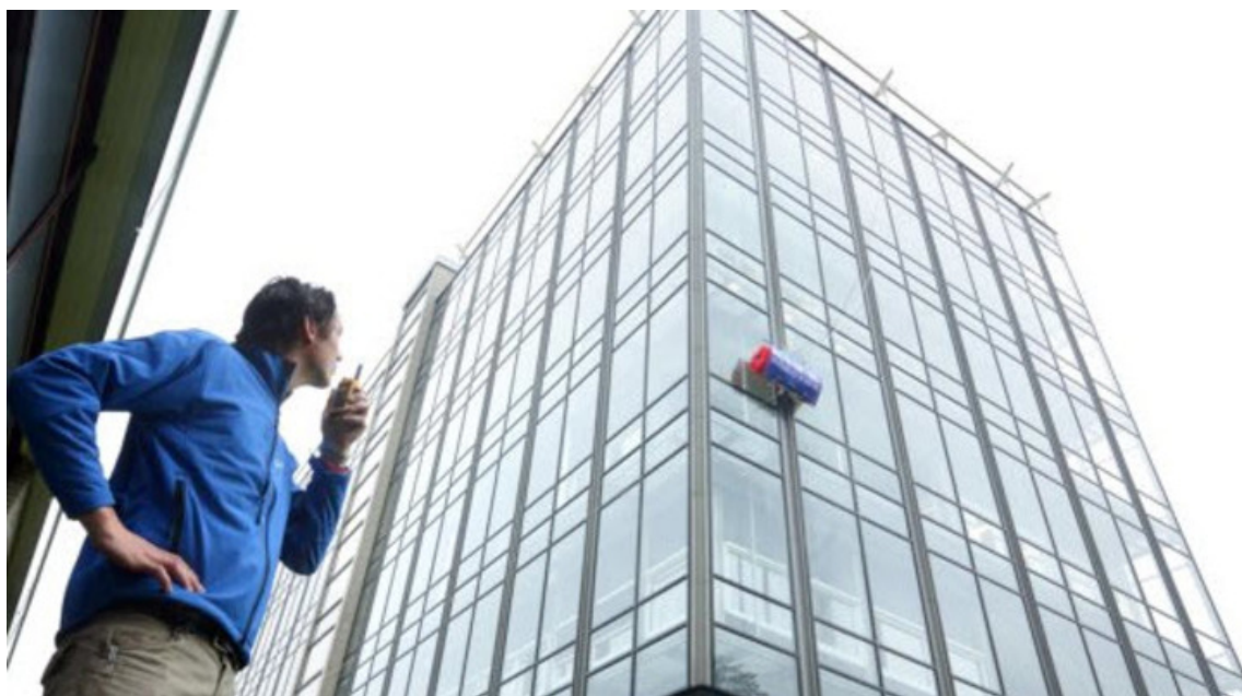
Obr. 2: Robotický uklízeč skleněných fasád. Zdroj: (51)
