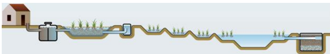
Obr.14 – KČOV s čistící kaskádou a zahradním jezírkem
