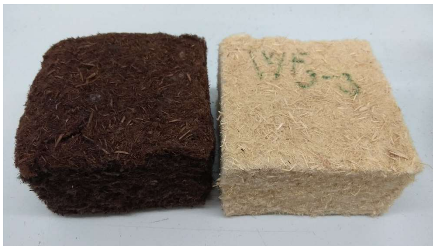
Obr. 49: Vzorky dřevovlákná před a po sušení za vysoké teploty
