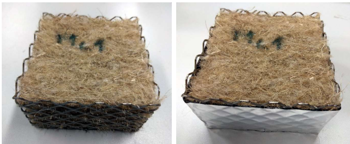
Obr. 20: Speciální klíčky z tahokovu z nerezové oceli pro absorpční test vláknitých materiálů
