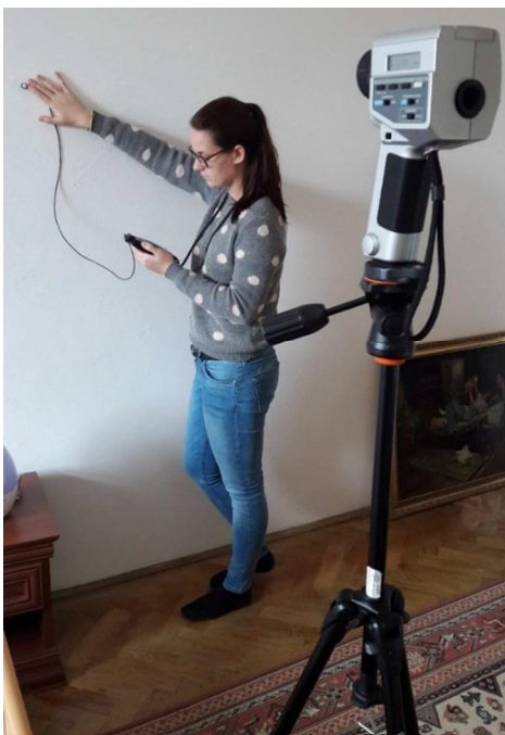
Obr. 7: Měření jasu a osvětlenosti povrchu pomocí luxmetru a jasoměru v bytě č. 2
