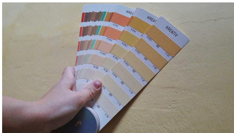
Obr. 10: Určování činitele odrazu světla stěny v bytě č. 1 pomocí vzorníku CEMIX [2]
