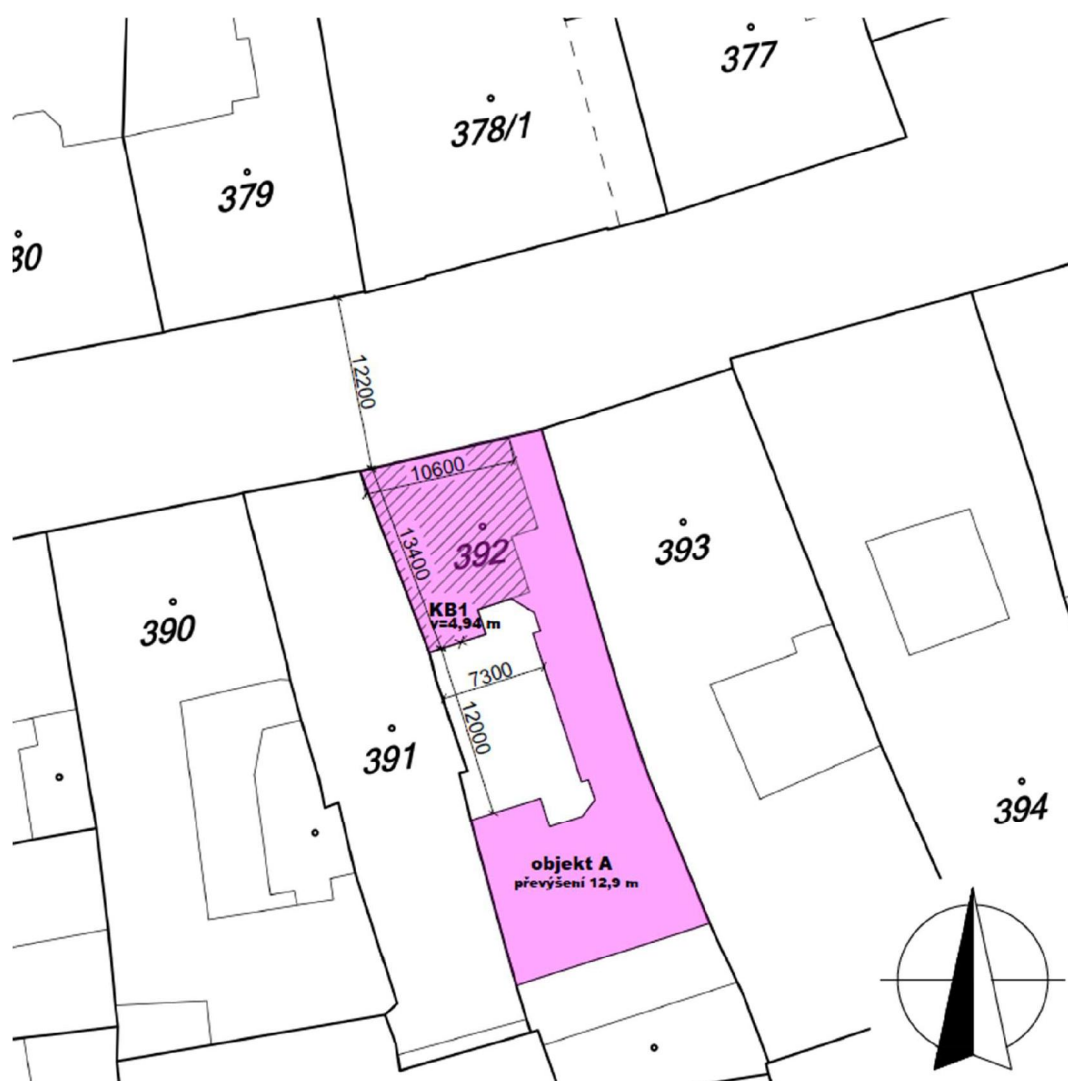
Obr. 59: Situace v M 1:500 – byt č. 3, vyznačení skutečného severu S_p a hlavních kót objektu; s využitím [12]
