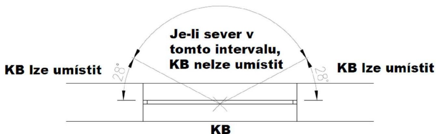
Obr. 6: Umístění kontrolního bodu KB, pokud je osvětlovací otvor orientován alespoň částečně na sever, s využitím [19]
