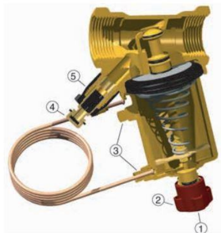
Obrázek č. 21: Řez RTD 1) Nastavení 2) Uzavírání 3) Připojení kapiláry, odvzdušnění, připojení pro měřicí vsuvku 4) Měřicí vsuvka 5) Připojení pro vypouštěcí nástavec [26]
