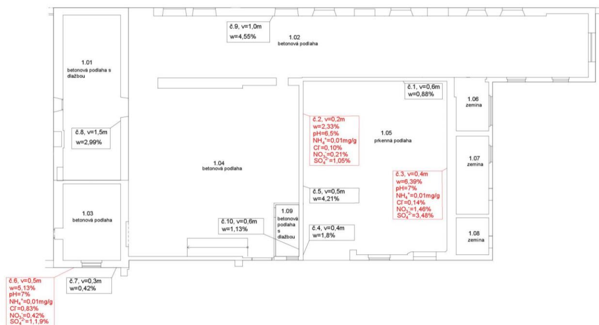
Obrázek č. 29 Schéma míst odebraných vzorků v 1.NP
