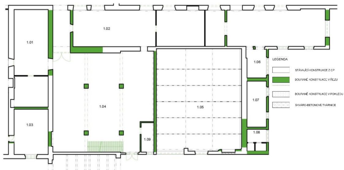
Obrázek č. 57 Půdorysné schéma bouracích prací - 1.NP
