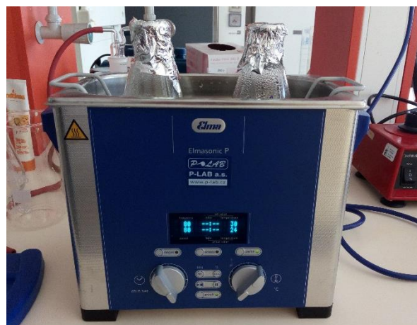
Obrázek č. 35 Ultrazvukový přístroj s vloženými vzorky [vlastní zdroj]
