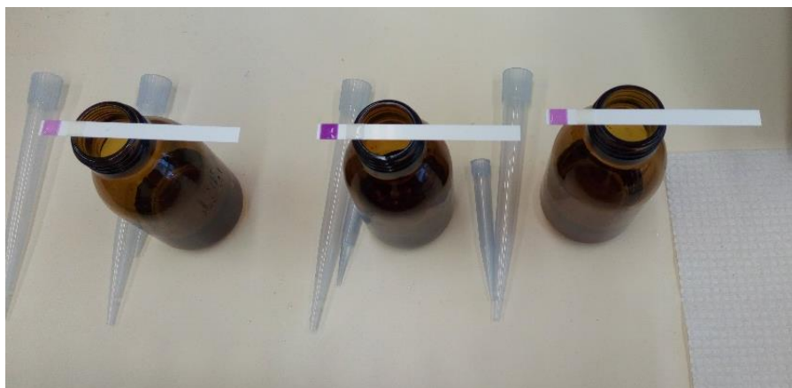
Obrázek č. 42 Kolorimetrická zkouška koncentrace dusičnanů [vlastní zdroj]
